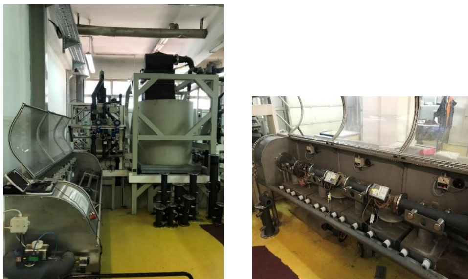
Slika 18. Mjerne linije za ispitivanje mjerila protoka
