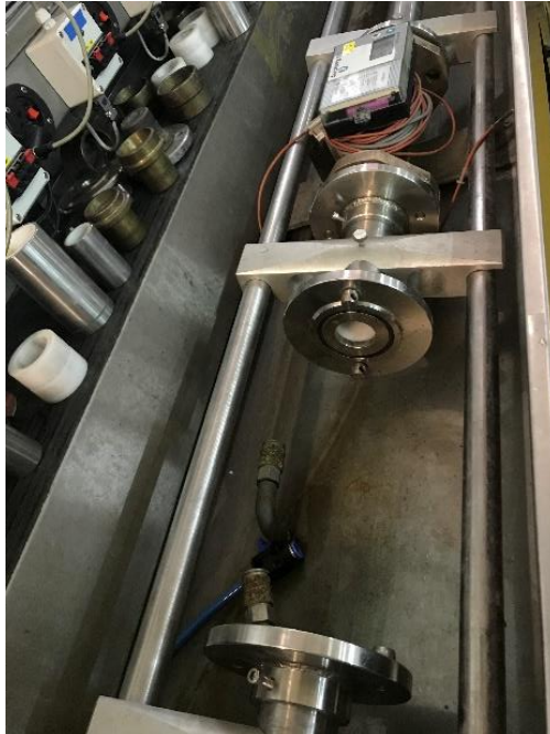
Slika 19. Montaža mjerila protoka na mjernu klupu JUSTOR
