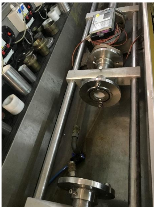
Slika 19. Montaža mjerila protoka na mjernu klupu JUSTOR
