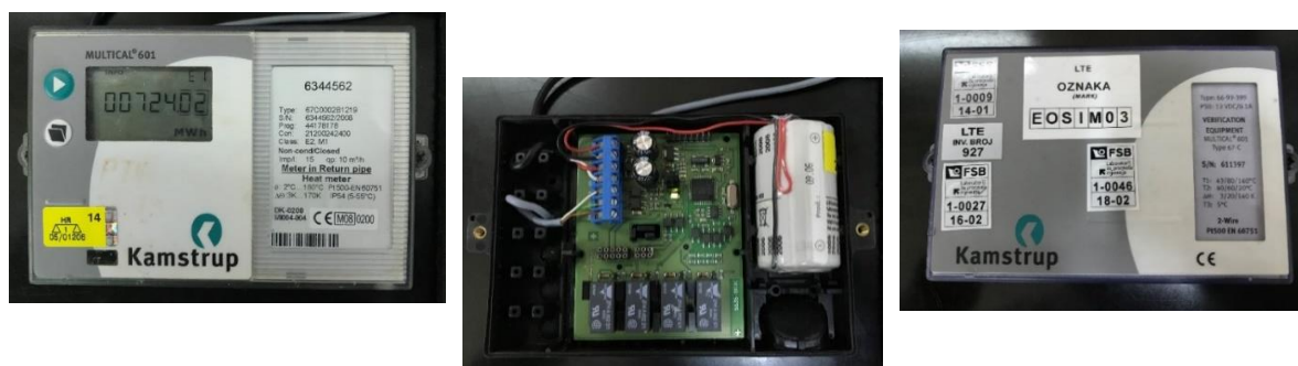
Slika 35. Montaža i prebacivanje računске jedinice u ispitni mod
