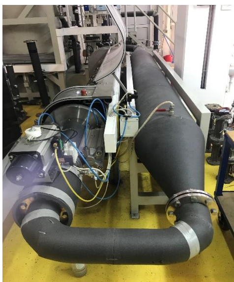
Slika 22. Smirivač protoka spojen na ispitnu klupu JUSTOR
