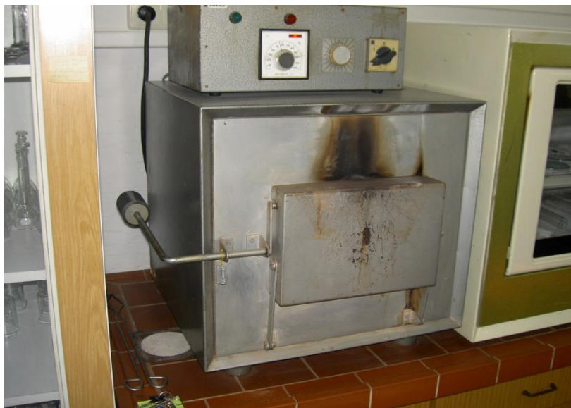
Slika 18. Laboratorijska električna peć za kalciniranje \text{TiO}_2 sol-gel keramičkih prevlaka
