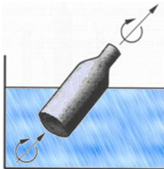
Slika 8. Pojednostavljen prikaz uranjanja i okretanja [1].
