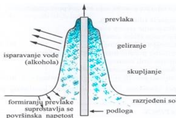
Slika 6. Prikaz procesa geliranja koji je proveden isparavanjem otapala i naknadnom destabilizacijom soli [1].
