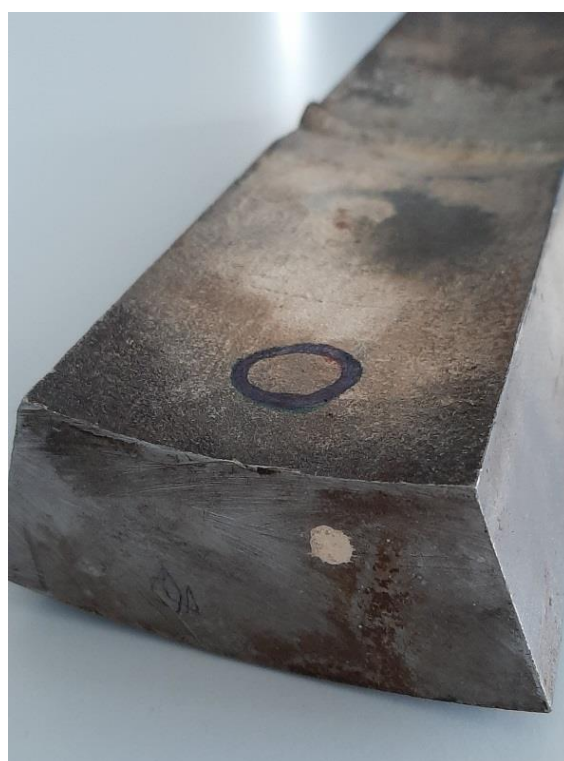
Uzorak 4: zakrivljen, konveksan uzorak
