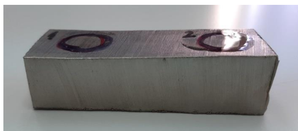
Uzorak 3: uzorak s neparalelnim površinama
