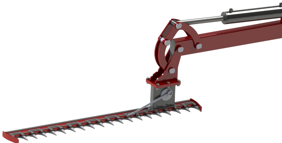
Slika 39. Prikaz kosišta i mehanizma za rotaciju kosišta
