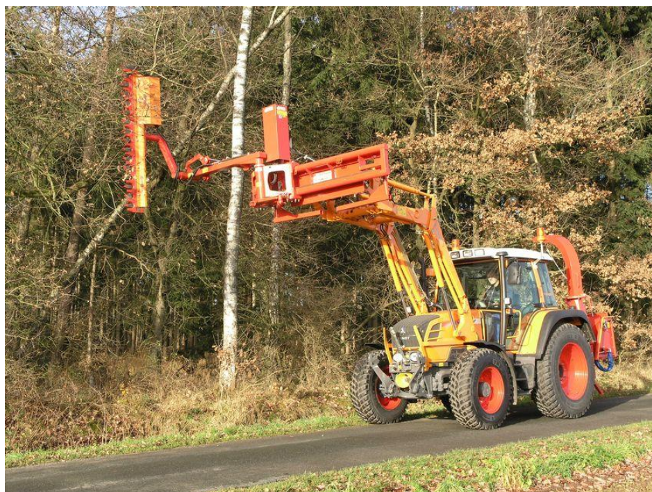
Slika 9. Uređaj za rezidbu granja Duecker [13]
