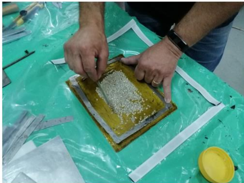
Slika 5.5 Ravnomjerna distribucija granulata
