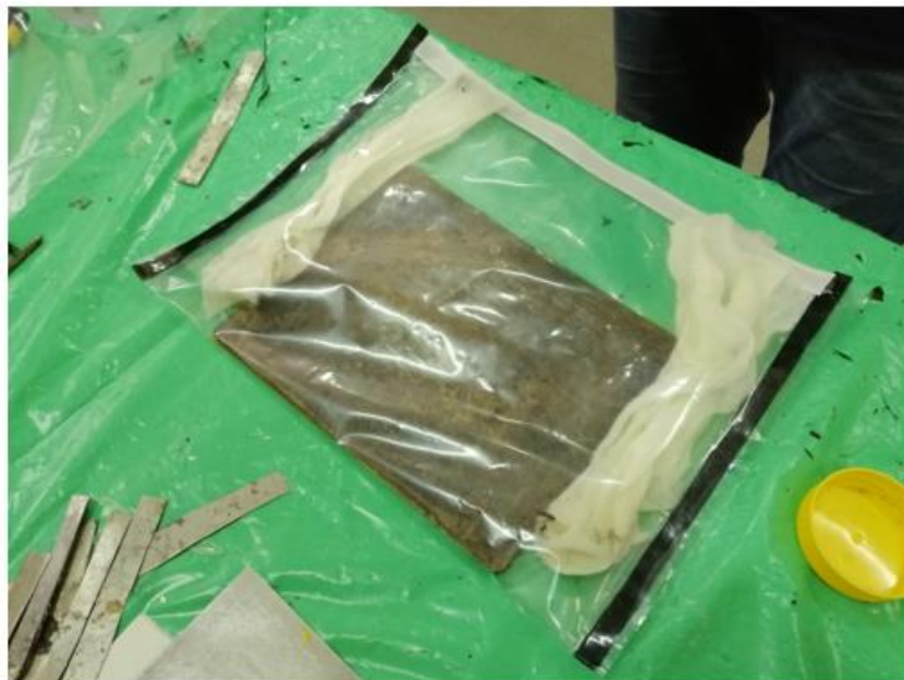
Slika 5.6 Izradak prije vakuumiranja i prešanja
