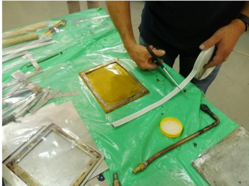
Slika 5.4 Priprema kalupa i vakuum folije
