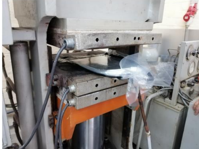
Slika 5.8 Stavljanje kalupa u prešu
