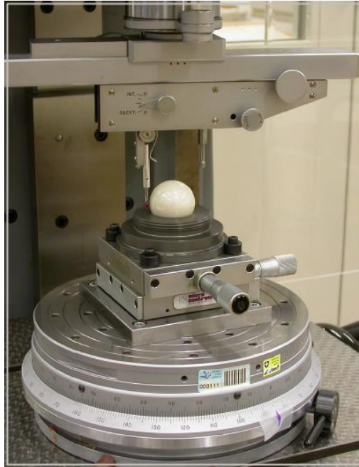
Slika 17 Ispitivanje mjerne kugle [12]
