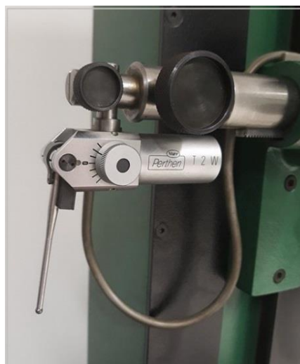
Slika 7 Induktivno ticalo uređaja za mjerenje kružnosti [2]
