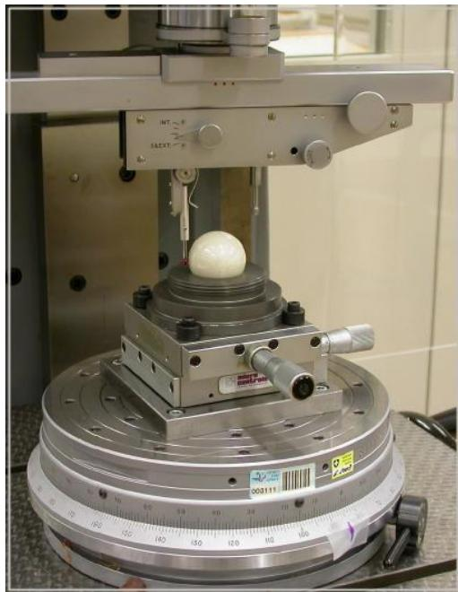
Slika 17 Ispitivanje mjerne kugle [12]
