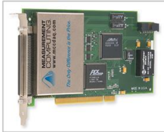
Slika 9 Kompjuterska kartica PCI – DAS6034 [5]
