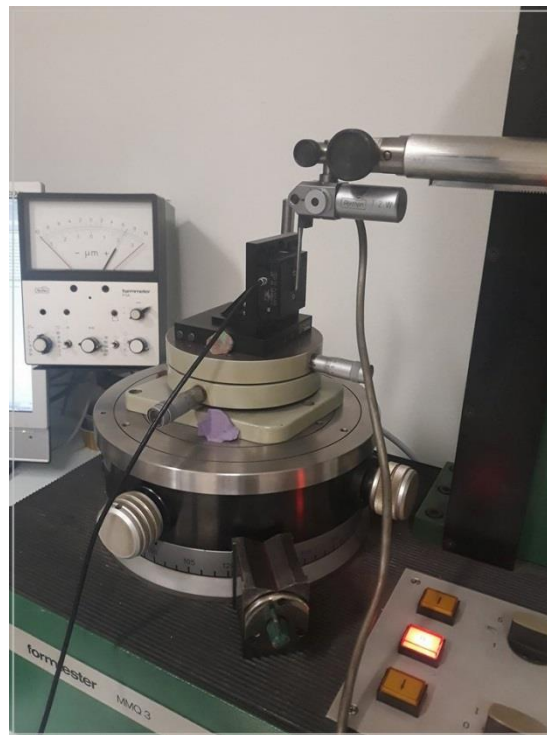
Slika 40 Postavljanje piezo aktuatora na MMQ-3 uređaj [2]
