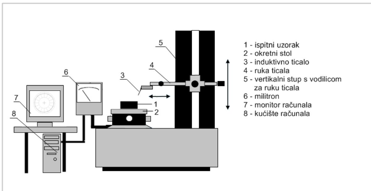
Slika 5 Osnovni dijelovi uređaja „MMQ-3“ za ispitivanje kružnosti [2]
