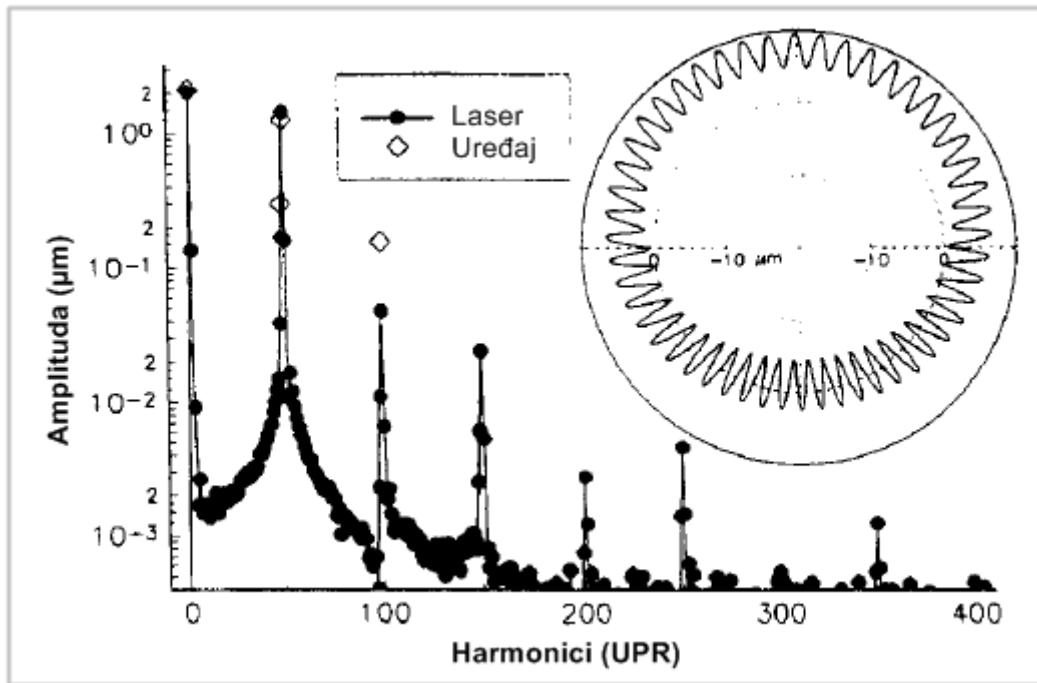
Slika 29 Amplitudni spektar izmjerenoj signala [17]
