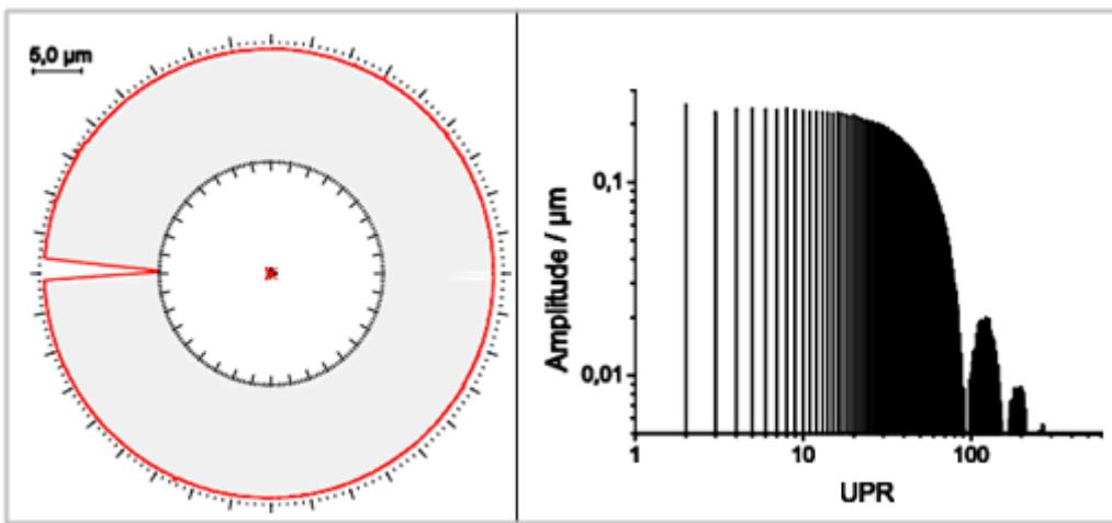
Slika 33 Simulirani Flick etalon i amplitudni spektar [10]
