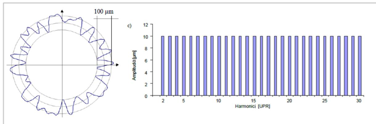
Slika 38 Asimetrični Multi-wave etalon [22]
