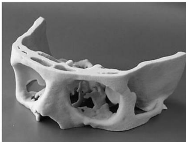
Slika 32. Kranijalni segment od trikalcij fosfata i beta trikalcij fosfata [38]
