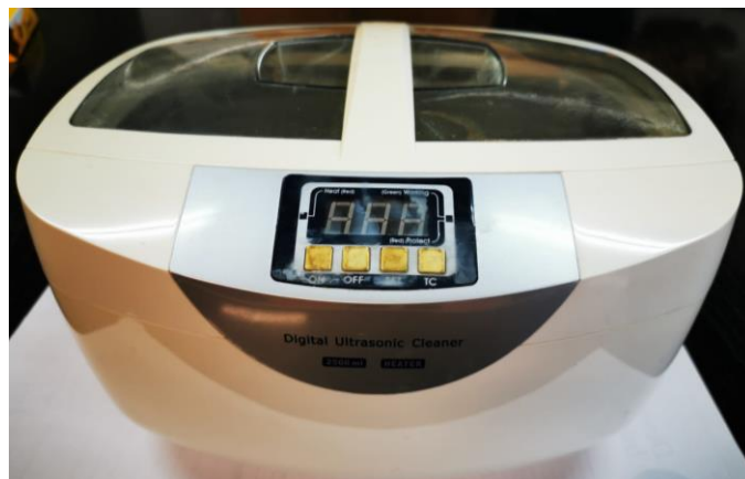
Slika 25. Digitalna ultrazvučna čistilica YM-4820 2.5 l
