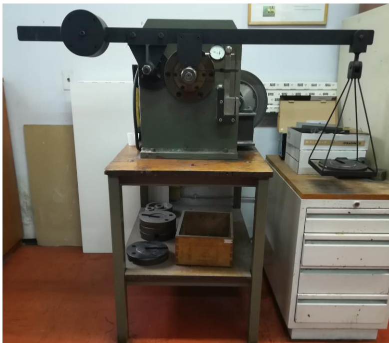
Slika 28. Uređaj za ispitivanje adhezijskog trošenja metodom prizma po prstenu
