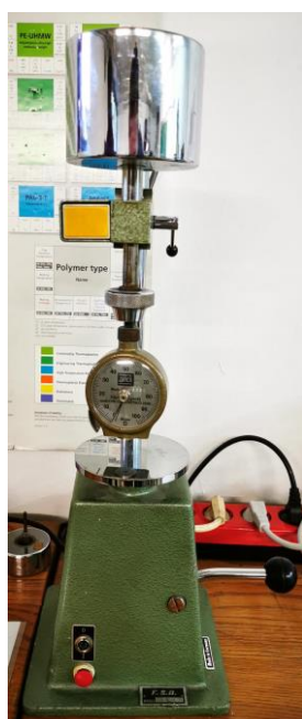
Slika 34. Uređaj za ispitivanje tvrdoće po Shore D
