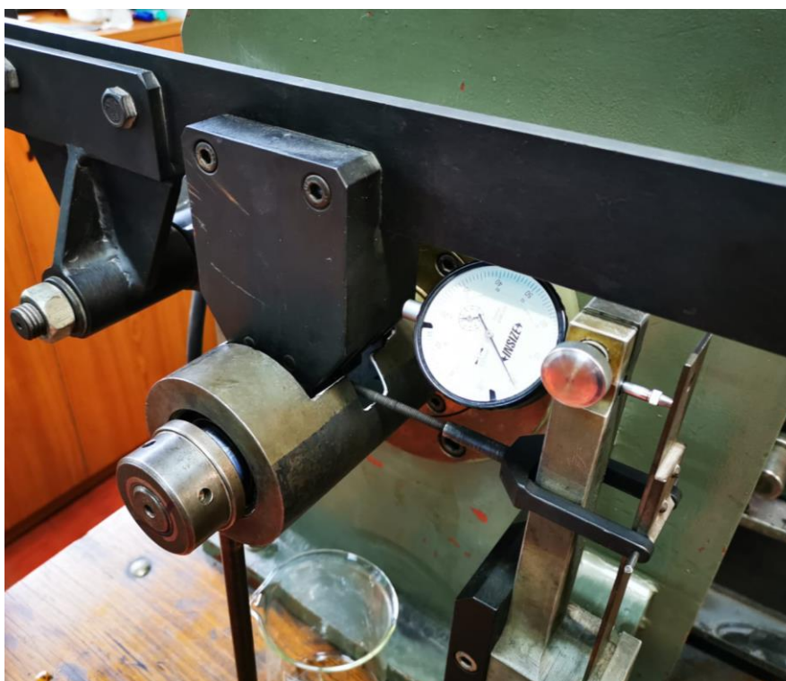
Slika 31. Ispitivanje adhezijskog trošenja u vlažnom stanju
