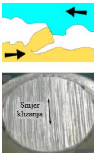
Slika 6. Abrazijsko trošenje poliamida [11]
