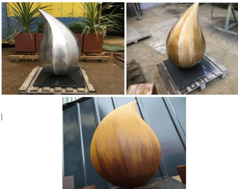
Slika 22. Promjena izgleda Cor-Ten čelika s vremenom [33]
