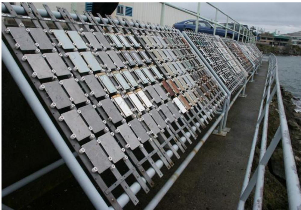
Slika 31. Stanica za ispitivanje atmosferske korozije smještene u Kanadi [37]
