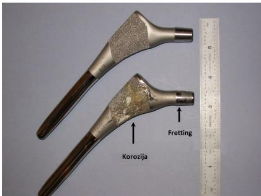
Slika 18. Korozivska oštećenja na femoralnom dijelu [9]
