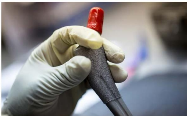
Slika 2. Mrežica od CP titana na femoralnom dijelu implantat [9]
