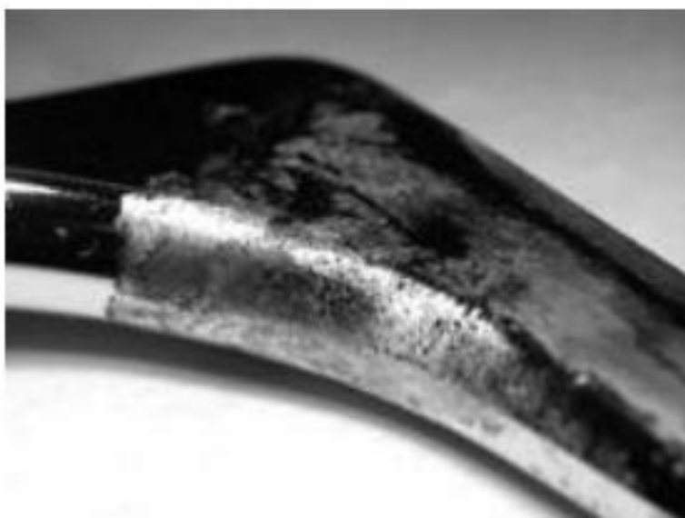
Slika 19. Korozivsko oštećenje implantata od nehrđajućeg čelika [16]
