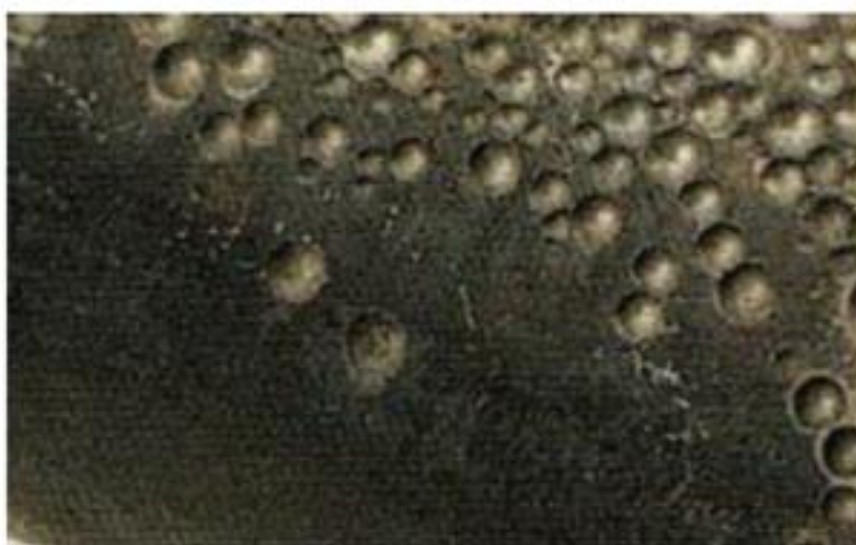
Slika 5. Pojavni oblik rupičaste korozije na titanovoj leguri [11]
