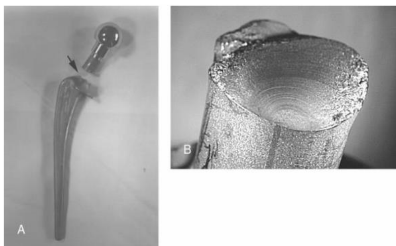
Slika 21. Lom zbog umora materijala [16]
