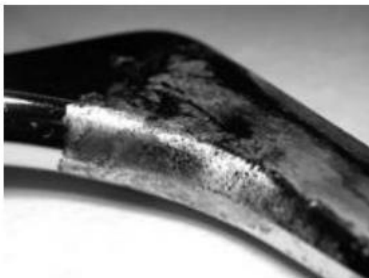
Slika 19. Korozijsko oštećenje implantata od nehrđajućeg čelika [16]
