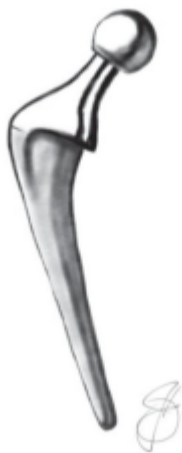
Slika 11. Charnelyjev dizajn proteze koji se sastoji od glave, vrata i stema [19]
