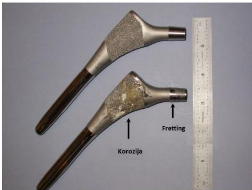
Slika 18. Korozijska oštećenja na femoralnom dijelu [9]
