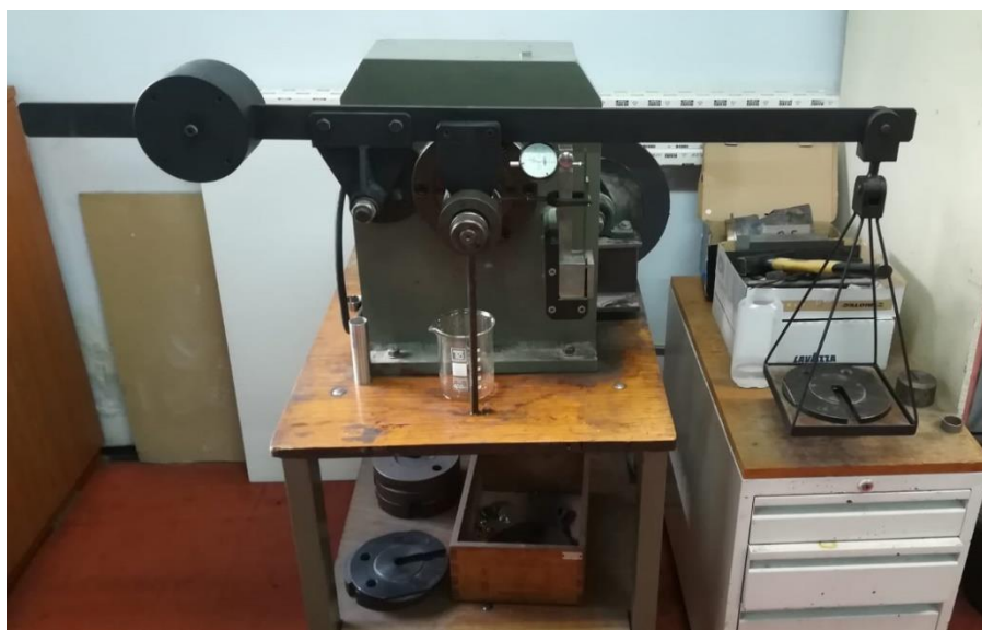
Slika 32. Ispitivanje adhezijskog trošenja "Block on ring" metodom
