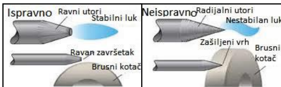
Slika 15. Ispravno i neispravno brušenje volframove elektrode [24]
