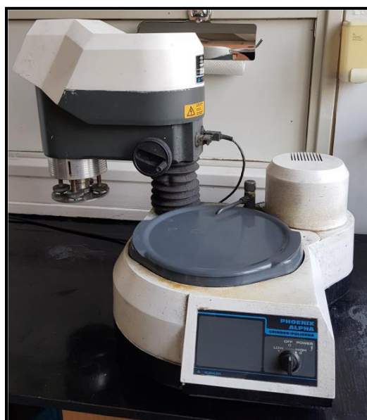
Slika 34. Uredaj za fino poliranje „Phoenix Alpha Grinder“
