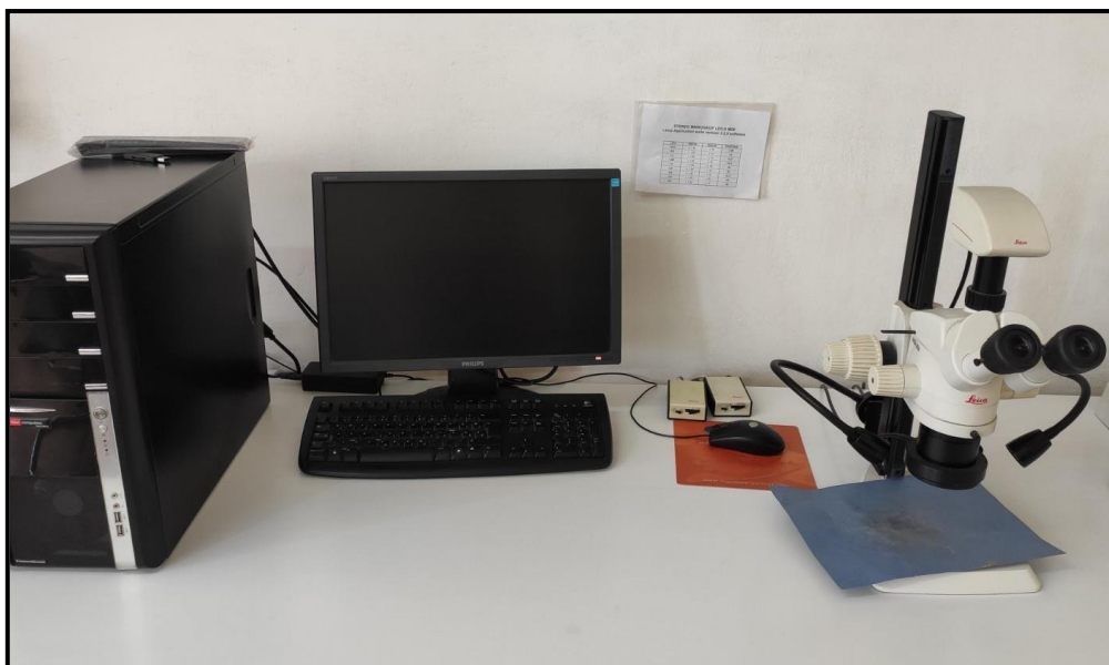
Slika 37. Snimanje makrouzoraka i obrada snimki – Leica MZ6 - program Leica App Suite
