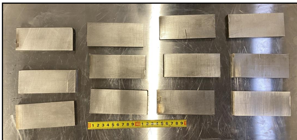
Slika 26. Izrezane ispitne pločice od osnovnog materijala
