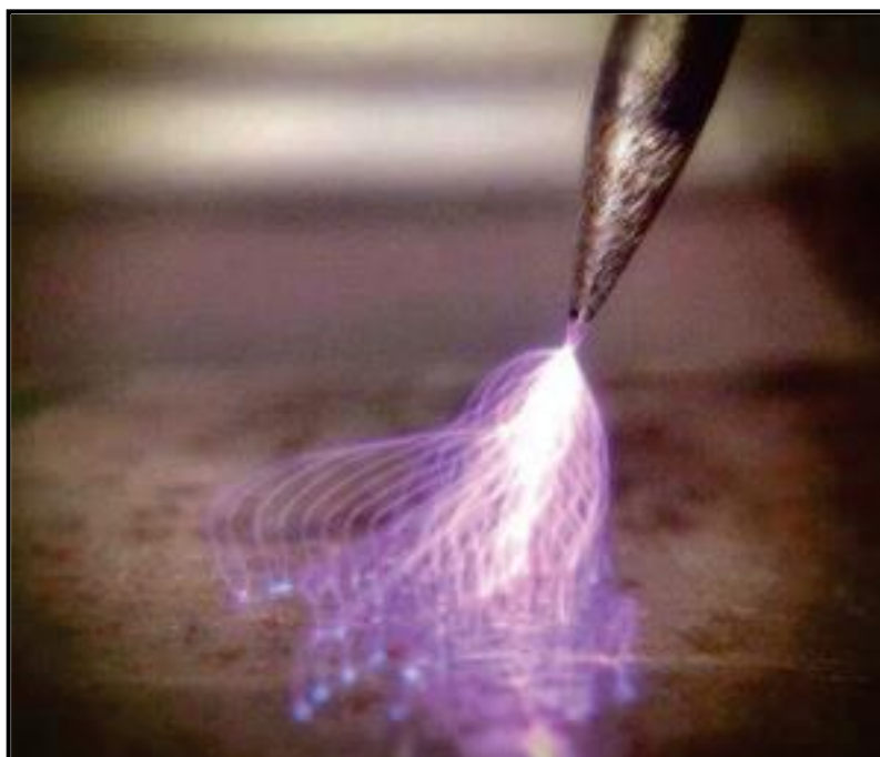
Slika 6. Uspostavljanje električnog luka uz pomoć visokofrekventnog generatora [9]
