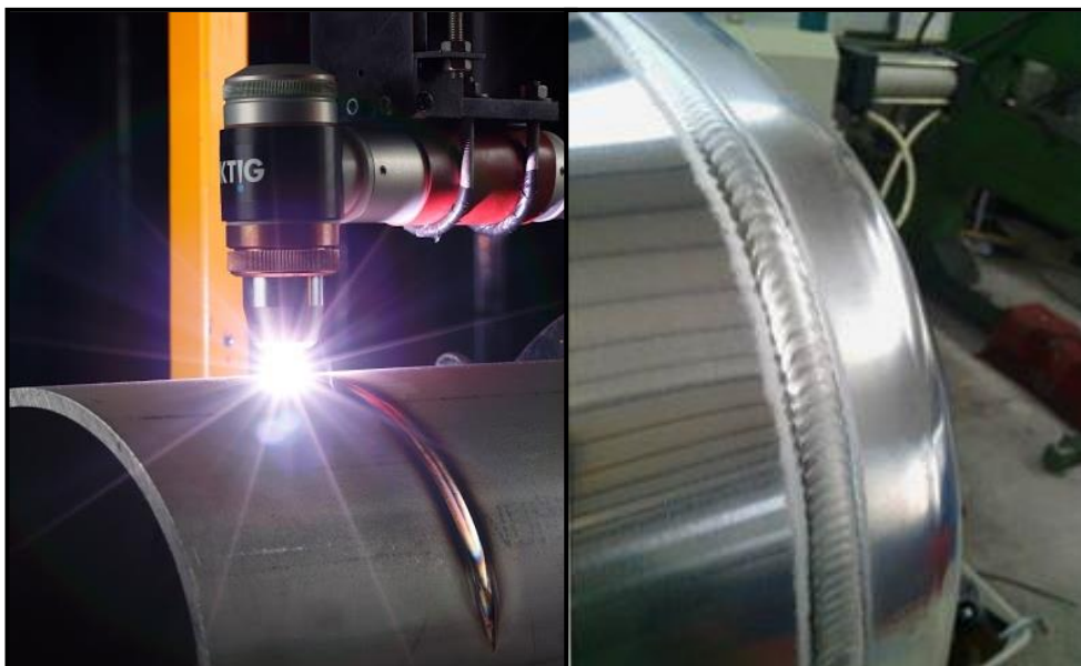
Slika 21. K – TIG zavarivanje [37]
