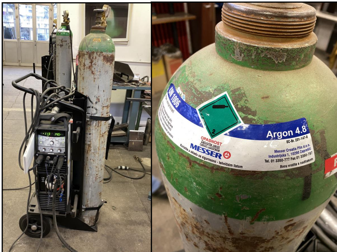
Slika 27. Zaštitni plin – Argon 4.8
