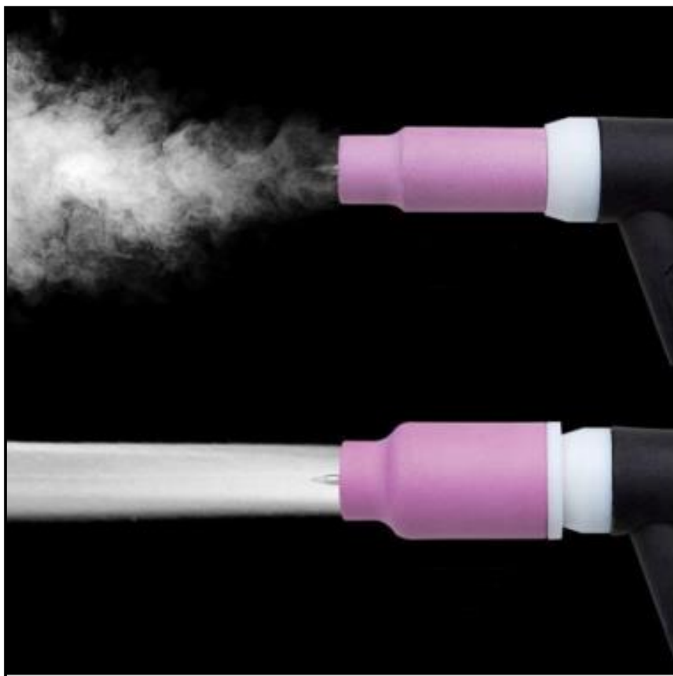
Slika 13. Ovisnost protoka zaštitnog plina o obliku sapnice [17]
