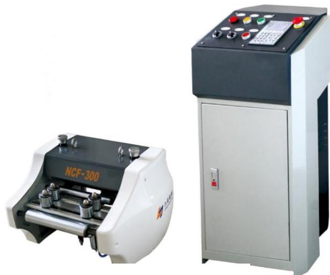
Slika 18. Servo dodavač sa upravljačkim ormarom [15]
