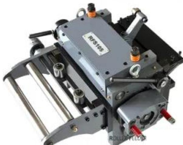
Slika 24. Visokobrzinski dodavač metalne trake (2000\$) [19]
