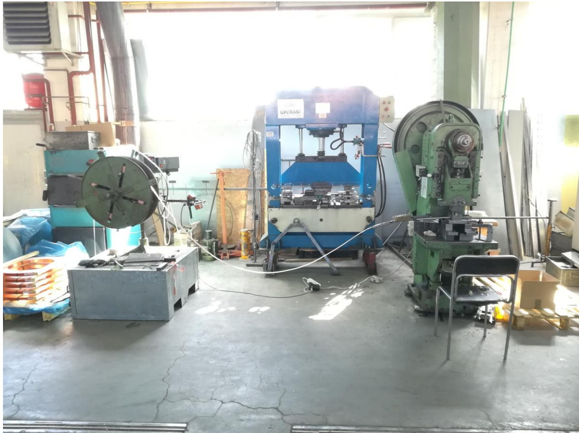
Slika 3. Odmatalica lijevo i ekscentar preša desno
