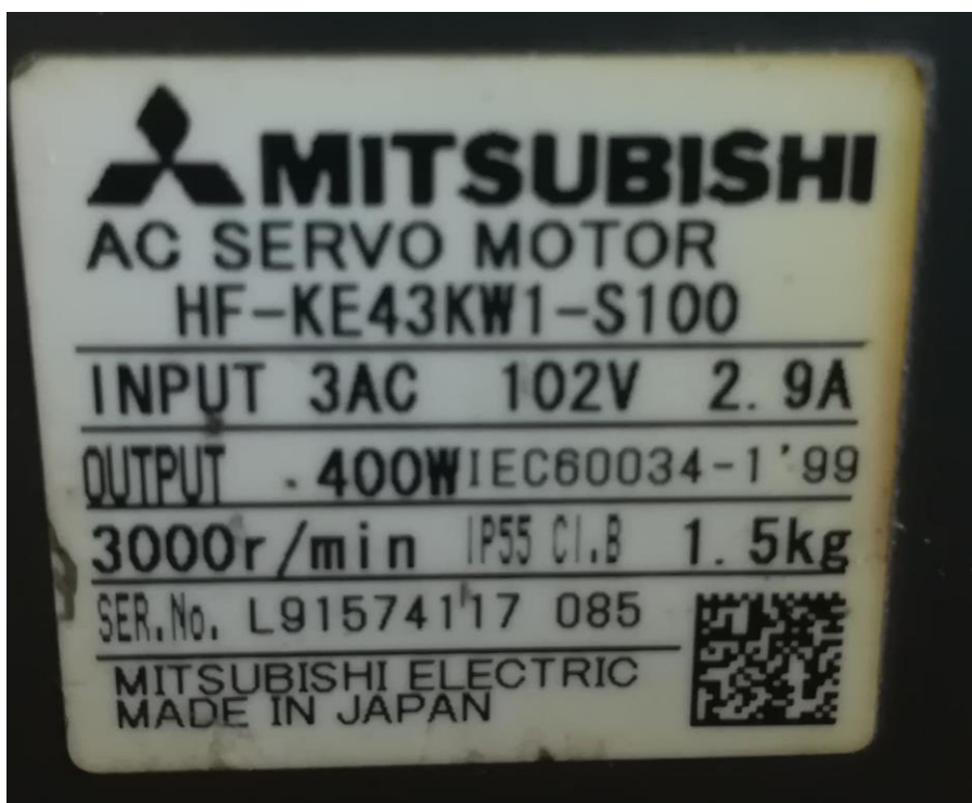
Slika 50. Natpisna pločica servo motora
