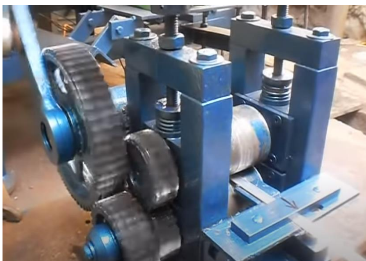
Slika 16. Pogon mehaničkog dodavača [13]
