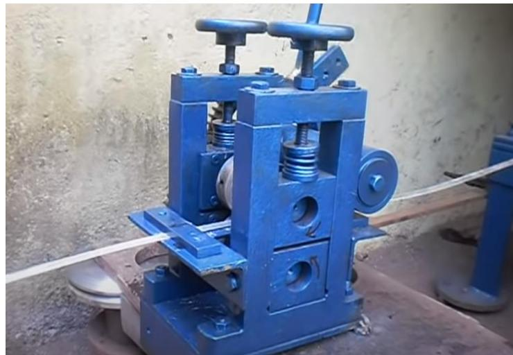
Slika 15. Mehanički dodavač [13]
