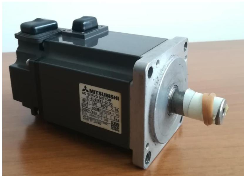
Slika 49. AC servo motor
