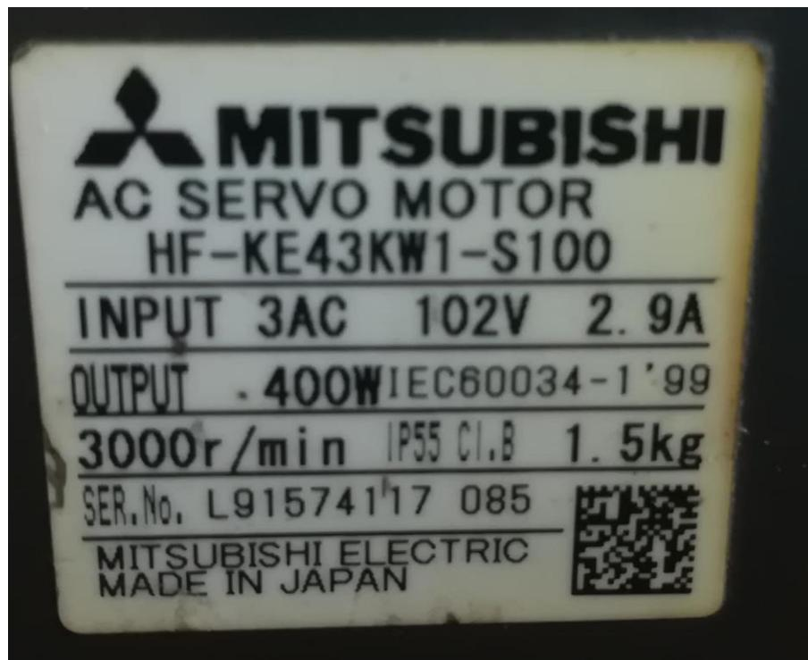
Slika 50. Natpisna pločica servo motora
