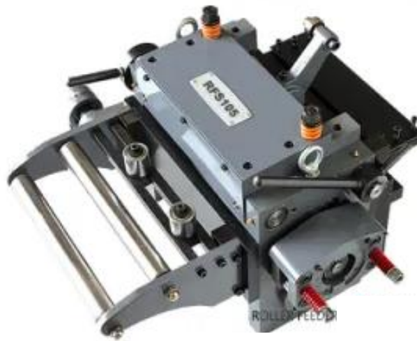
Slika 24. Visokobrzinski dodavač metalne trake (2000$) [19]
