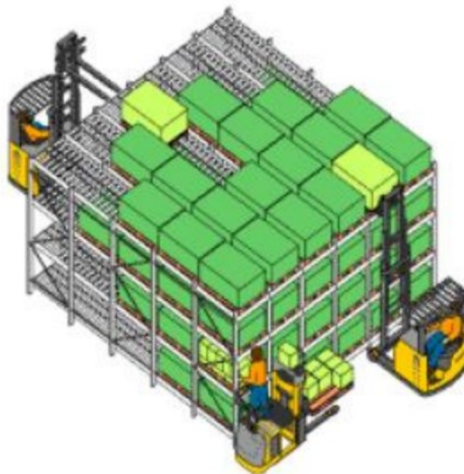
Slika 19. Protočni regal, FIFO sistem [1]
