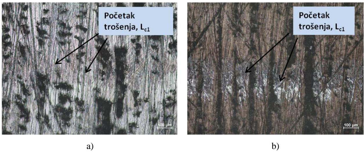
Slika 6.41: Početak adhezijskog trošenja,  $L_{c1}$ : a) uzorak P0, b) uzorak DH1
