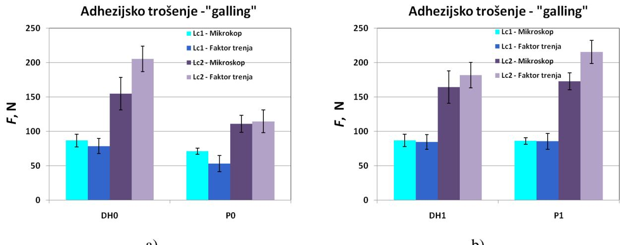
Slika 6.40: Rezultati ispitivanja otpornosti na adhezijsko trošenje metodom „load scanning test“ : a) uzorci DH0 i P0
