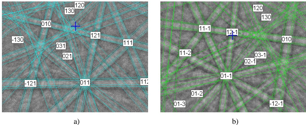
Slika 7.2: Indeksirana EBSD slika  $\text{Fe}_3\text{W}_3\text{C}$  karbida: a) uzorak P0, b) uzorak DH0
