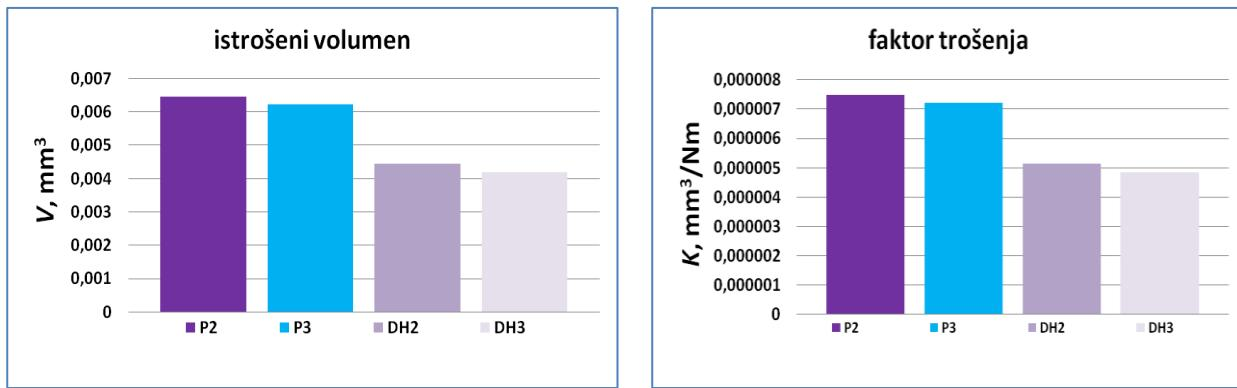
Slika 6.82: Rezultati ispitivanja trošenja metodom „kuglica na ploči“ na uzorcima s prevlakama:
