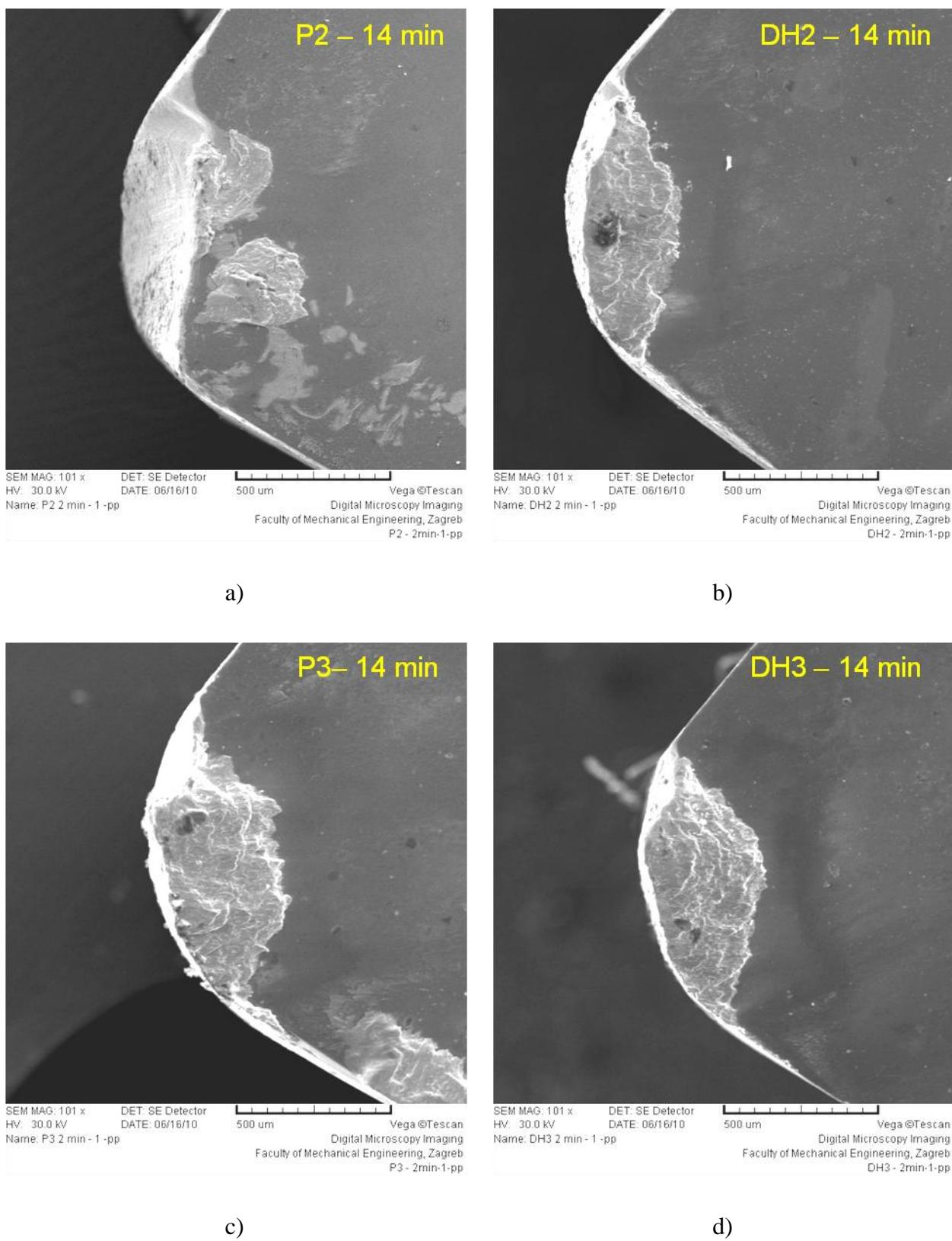
Slika 6.98: SEM fotografije trošenja prednje površine ispitivanih reznih pločica
