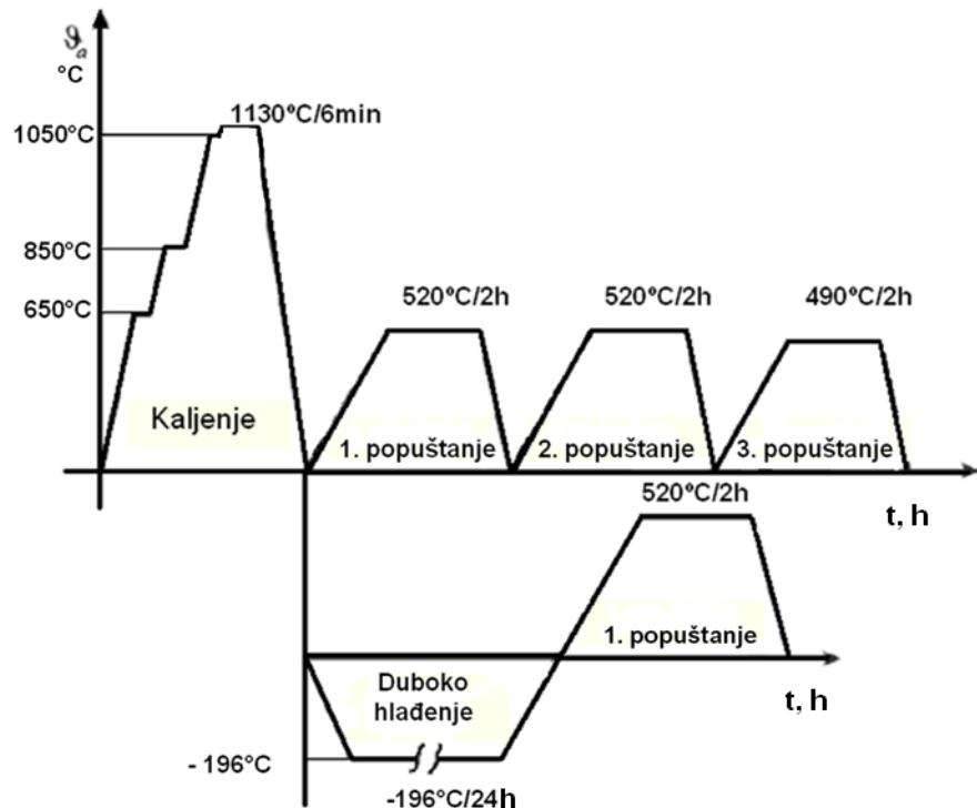
Slika 6.2: Dijagram postupka provedene toplinske obrade
