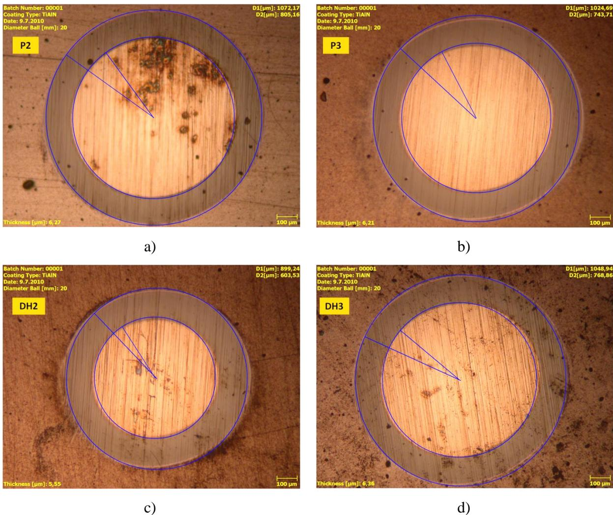
Slika 6.83: Tragovi trošenja nakon mikroabrazijskog ispitivanja kalotestom: a) P2, b) P3, c) DH2, d) DH3
