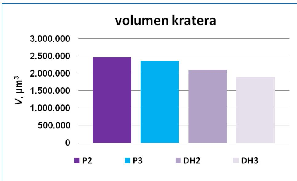
Slika 6.84: Volumen kratera nakon ispitivanja mikroabrazivskog trošenja
