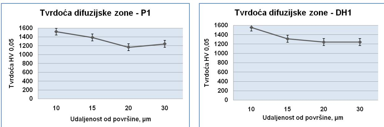
Slika 6.8: a) Tvrdoća po poprečnom presjeku uzorka P1
