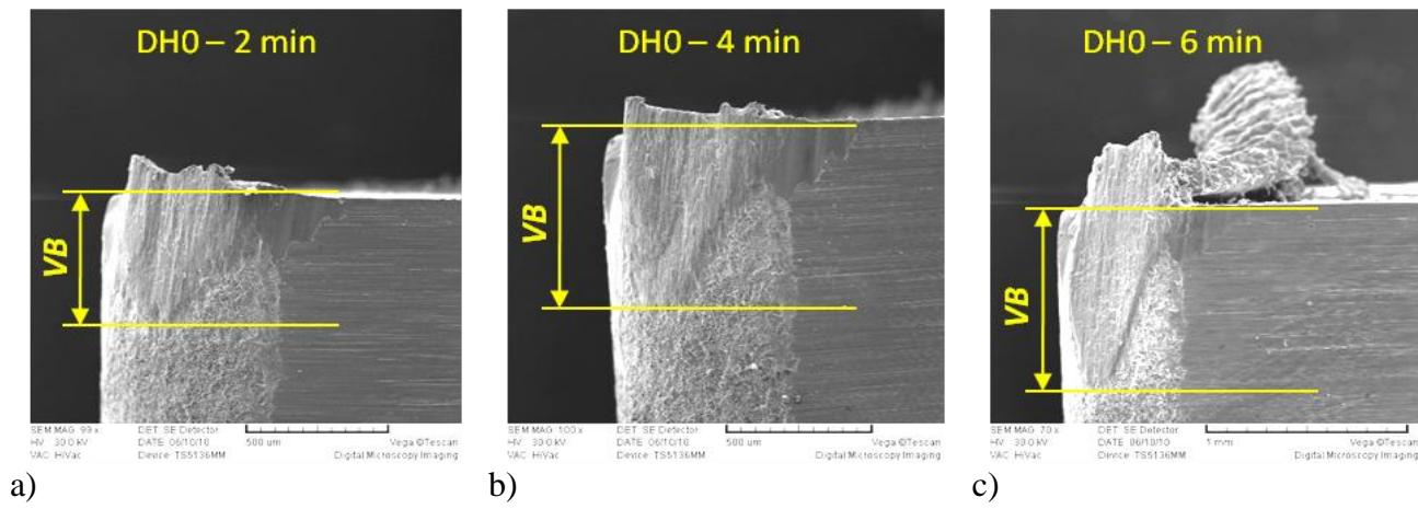
Slika 6.94: SEM slike trošenja alata stanja DH0 pri snimanju krivulje trošenja nakon
