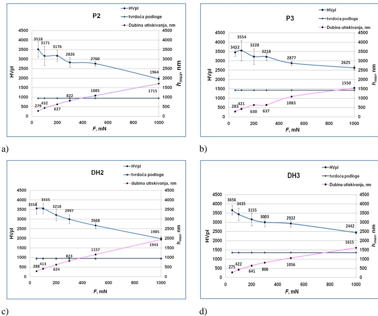
Slika 6.70: Vrijednosti mikrotvrdće i dubine utiskivanja: a) P2, b) P3, c) DH2, d) DH3
