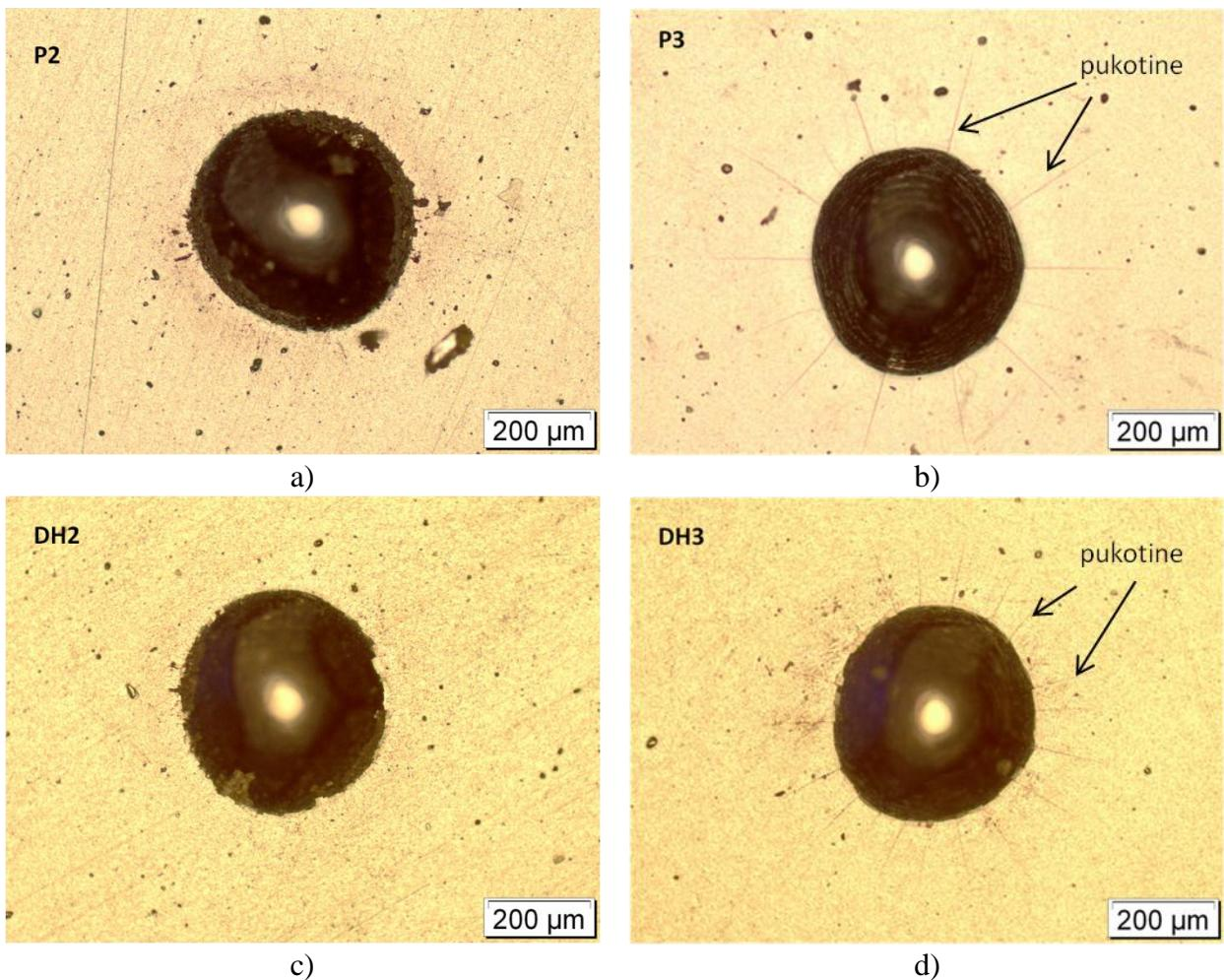
Slika 6.78: Rezultati ispitivanja prionjivosti prevlake Rockwellovom metodom:
