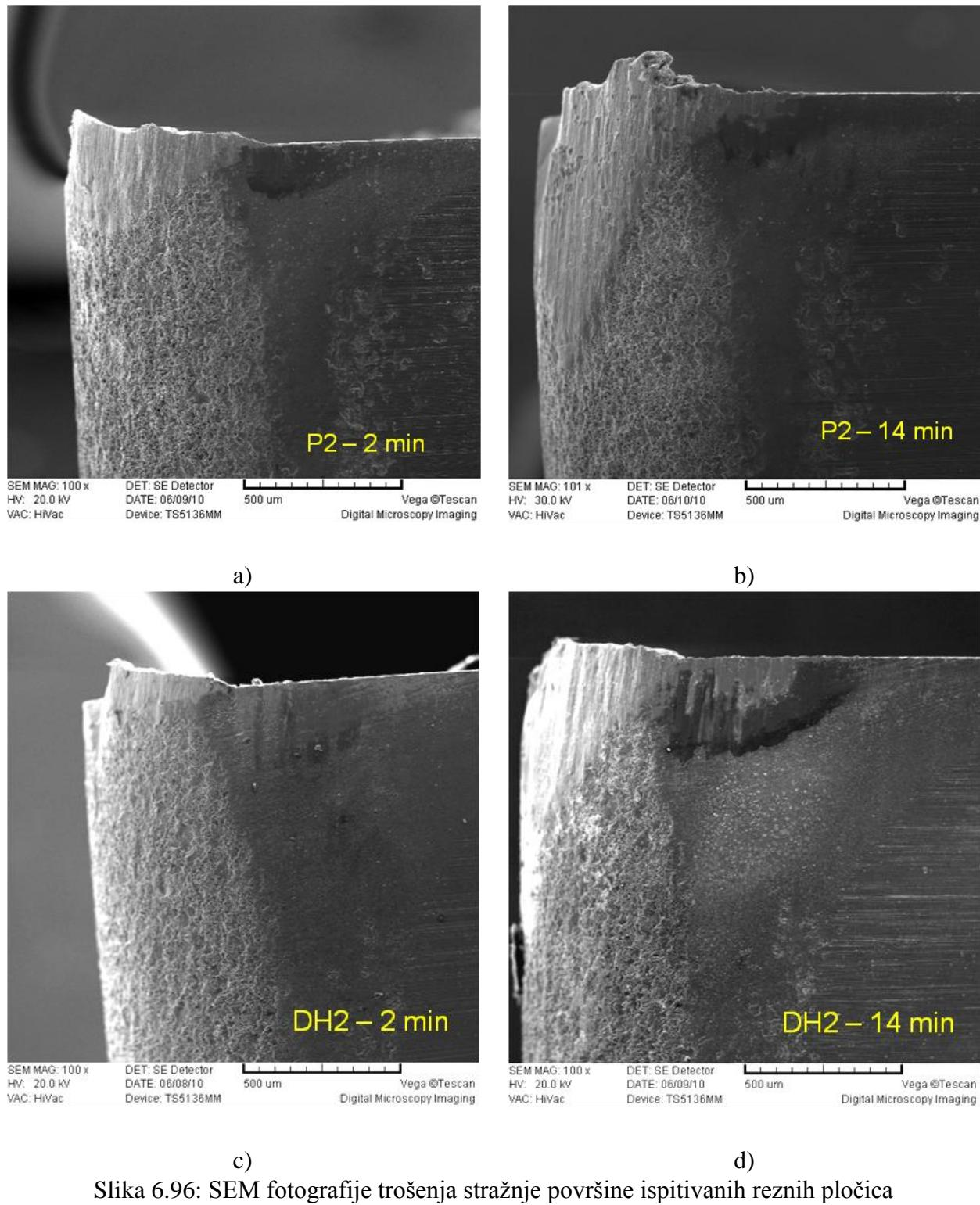
Slika 6.96: SEM fotografije trošenja stražnje površine ispitivanih reznih pločica
