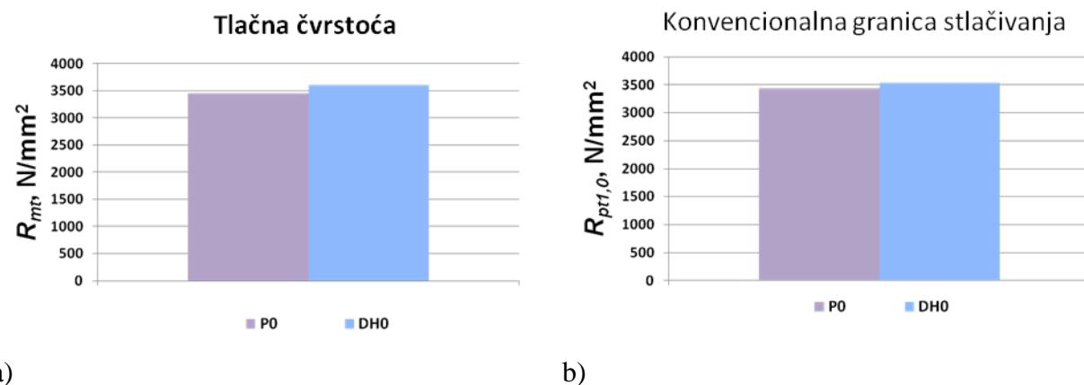
Slika 6.37: Uzorci P0 i DH0 a) tlačna čvrstoća, b) konvencionalna granica stlačivanja
