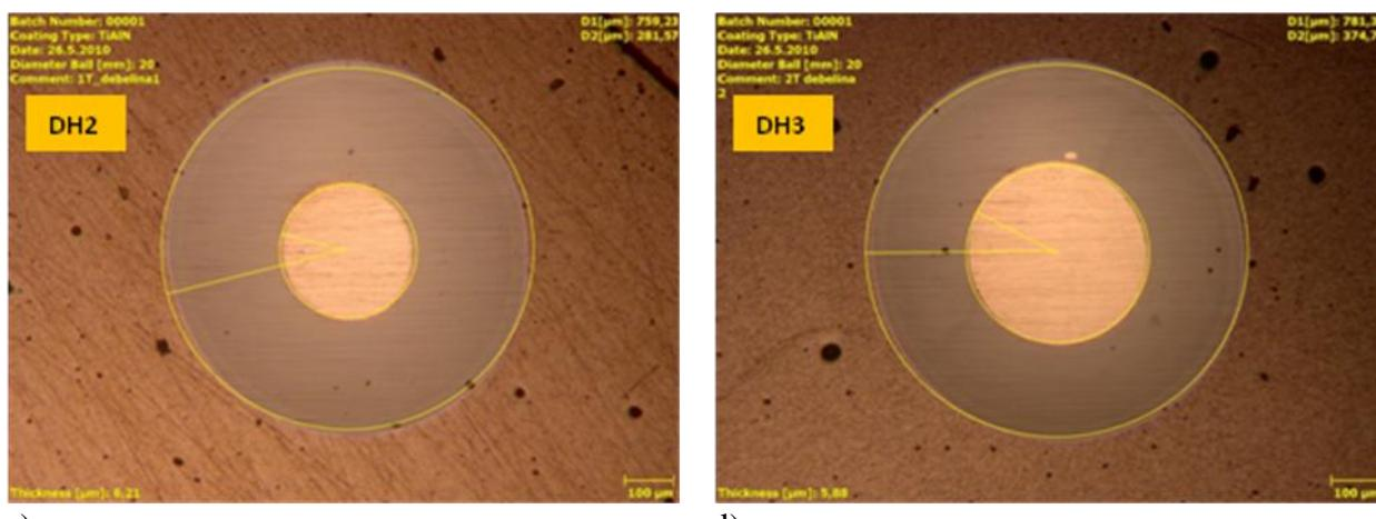
Slika 6.66: Tragovi trošenja na ispitnim uzorcima: a) P2, b) P3, c) DH2, d) DH3
