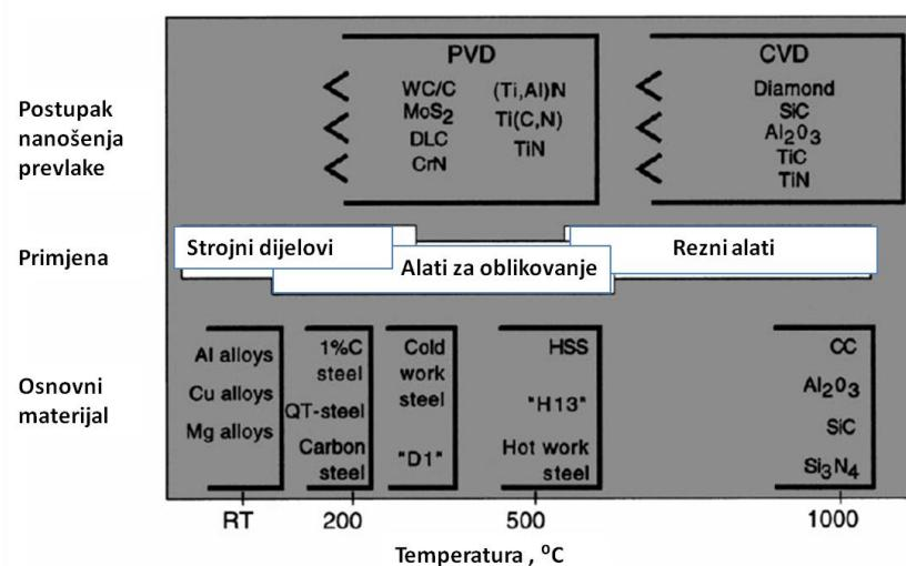
Slika 5.1: Usporedba PVD i CVD postupka nanošenja prevlaka [44]
