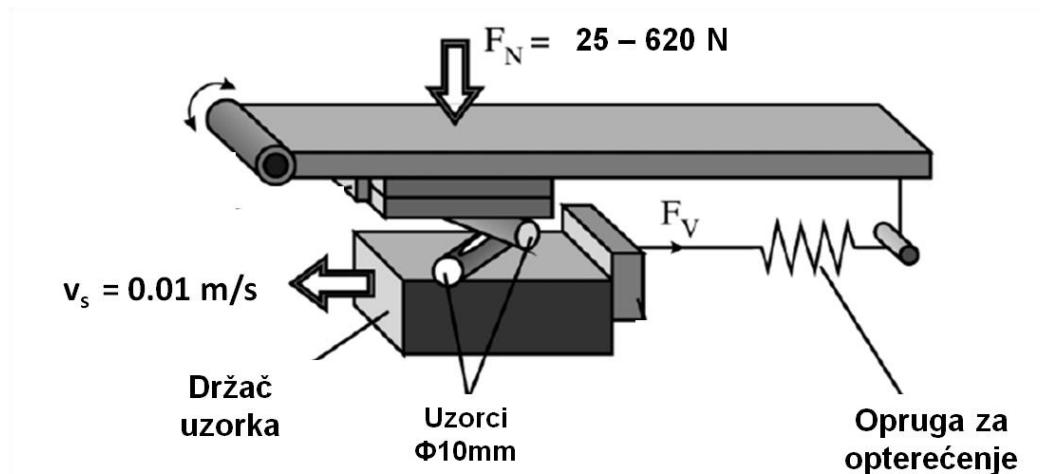
Slika 6.39: Shematski prikaz „load scanning testa“ za ispitivanje otpornosti na adhezijsko trošenje naljepljivanjem [53]
