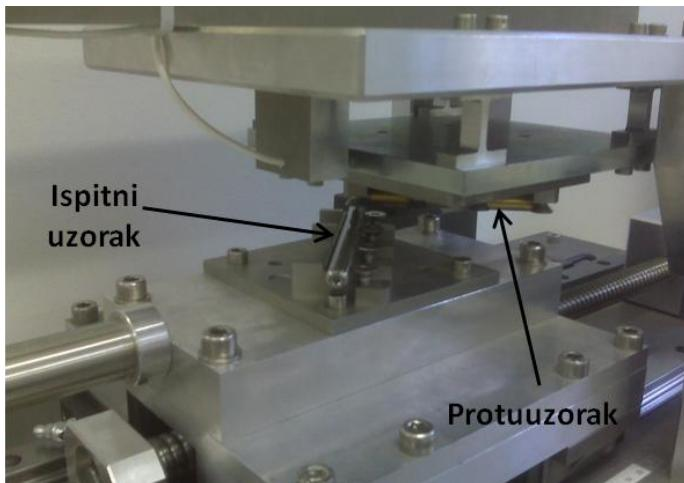
Slika 6.38: Uredaj za ispitivanje otpornosti na adhezijsko trošenje naljepljivanjem
