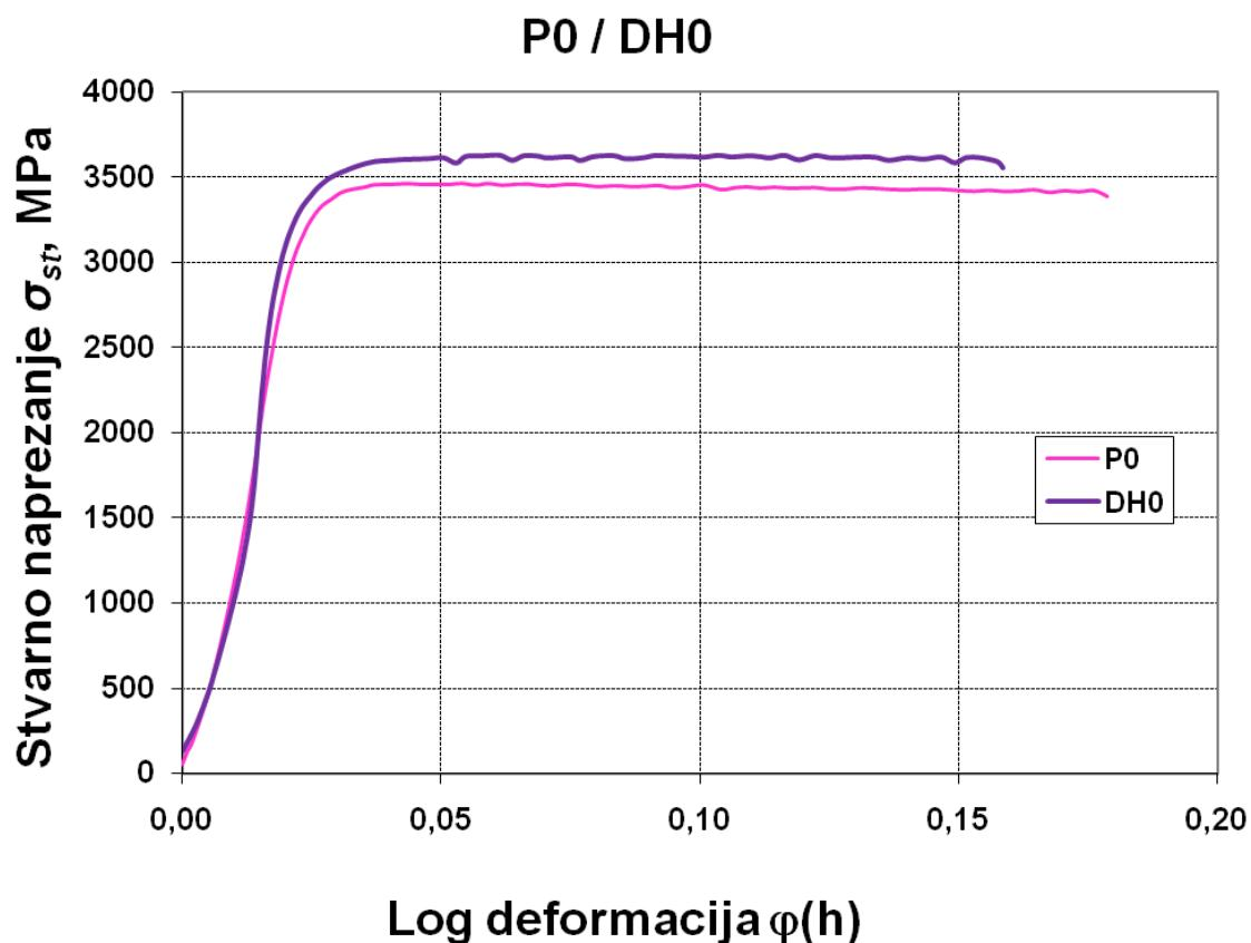
Slika 6.36: Dijagram naprezanje – deformacija za uzorce P0 i DH0
