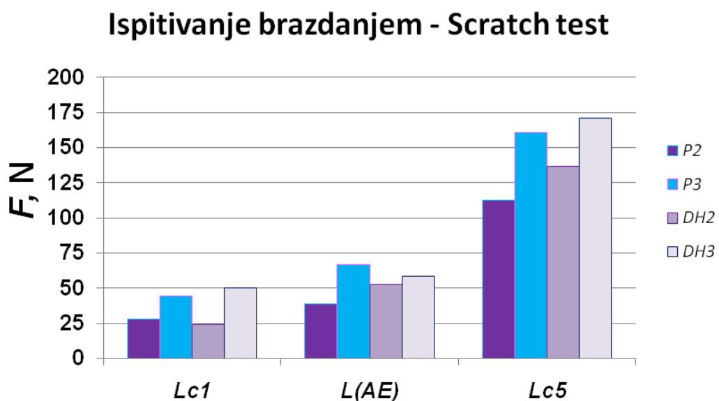
Slika 6.76: Kritične sile pri ispitivanju prionjivosti TiAlN prevlake na brzoreznom čeliku PM S390
