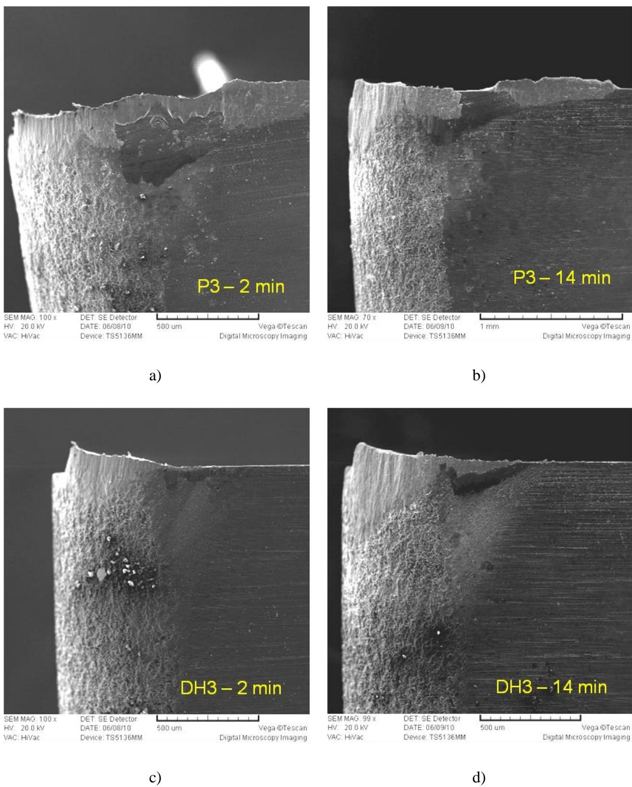
Slika 6.97: SEM fotografije trošenja stražnje površine ispitivanih reznih pločica
