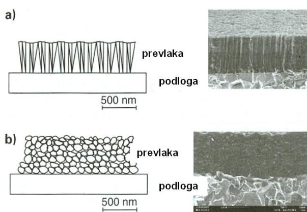
Slika 6.49: Shematski prikaz stupičaste (a) i finozrnate (b) mikrostrukture prevlake [18]
