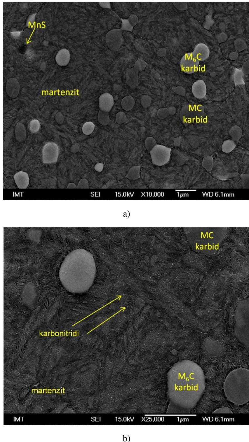
Slika 6.14: Mikrostruktura difuzijske zone uzorka DH1, a) manje povećanje b) veće povećanje
