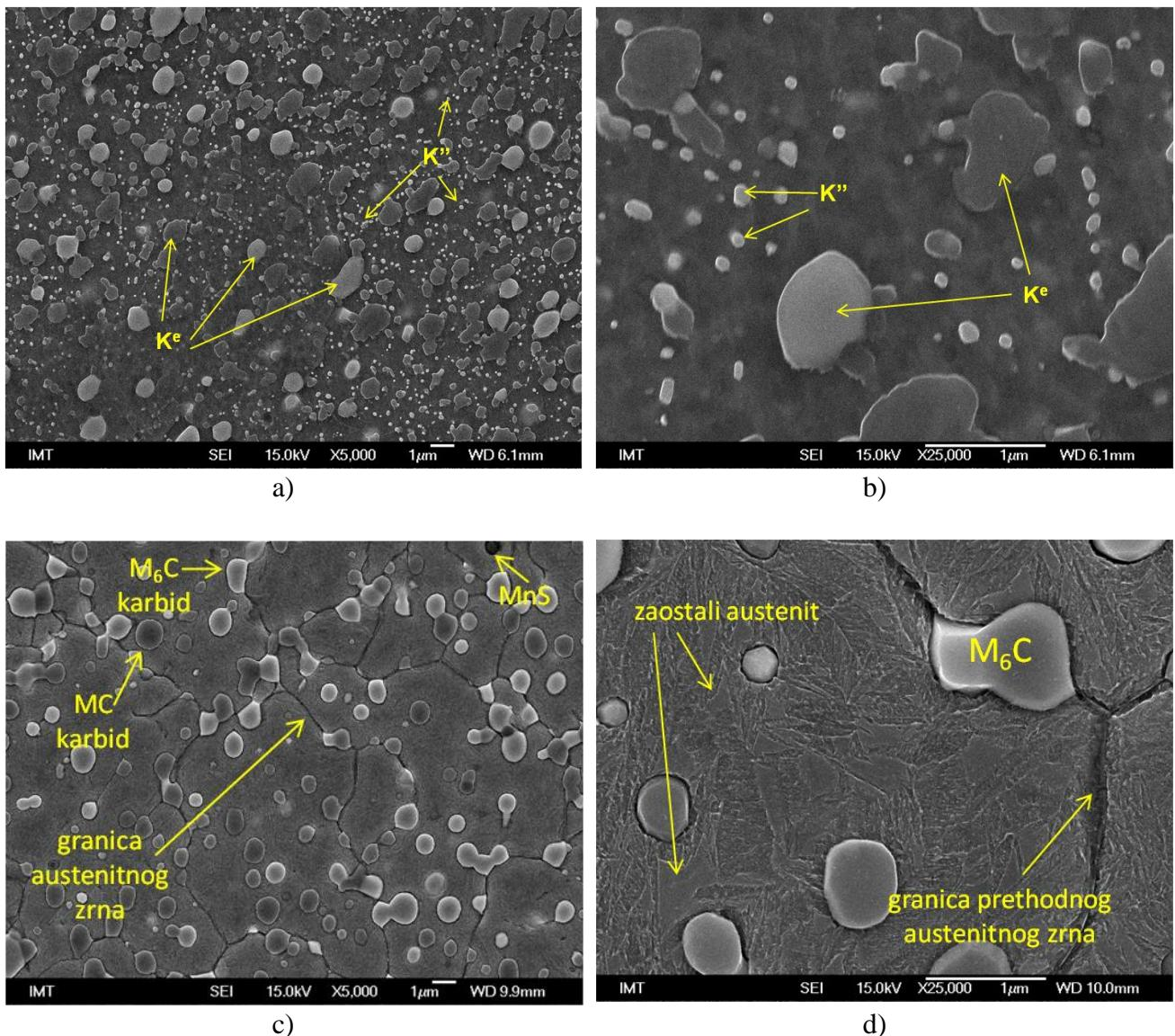
Slika 6.3: Mikrostruktura PM S390 MC brzoreznog čelika:
