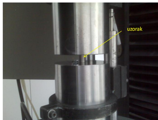
Slika 6.34: a) Univerzalni ispitni uređaj Instron 1255 b) Detalj sa slike a)
