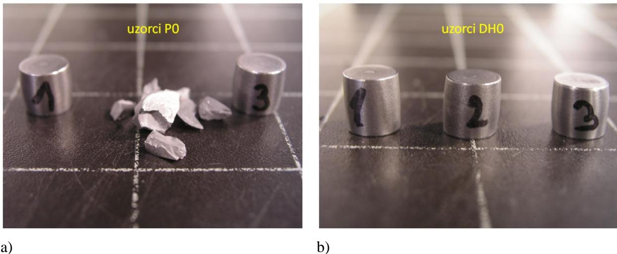
Slika 6.35: Ispitni uzorci nakon ispitivanje tlačne čvrstoće a) stanje P0, b) stanje DH0
