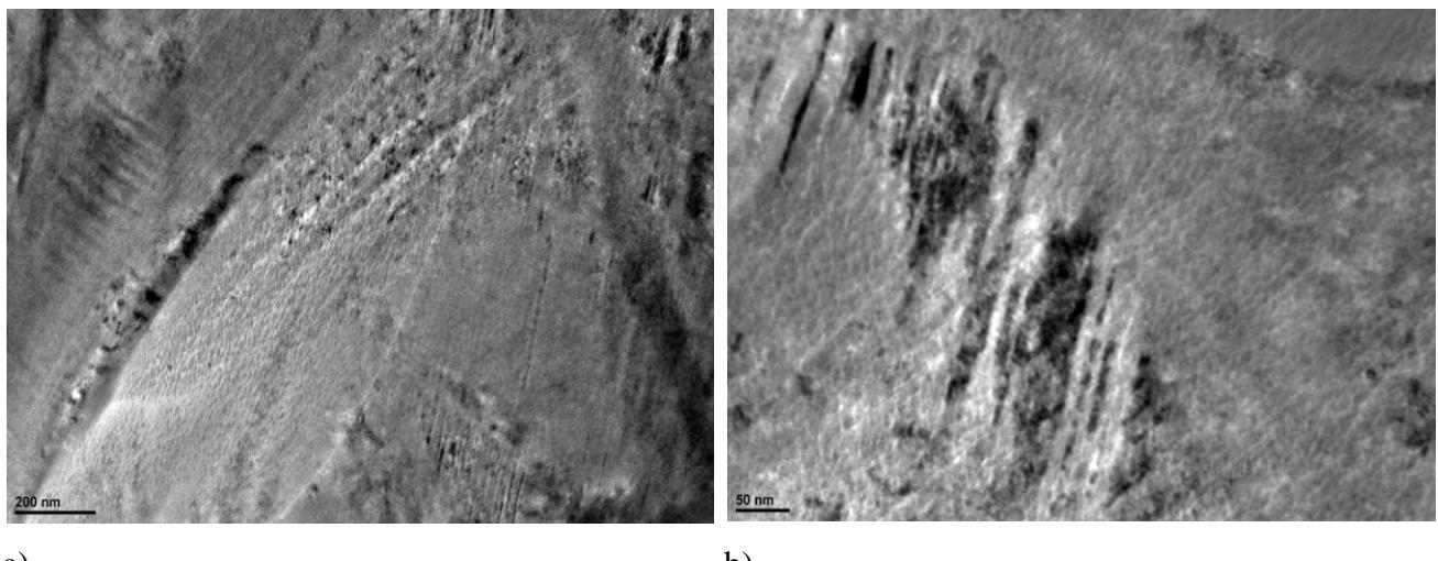
Slika 4.2: TEM slike martenzita i izlučenih precipitata u kaljenom i popuštenom PM S390 MC brzoreznom čeliku a) manje povećanje, b) veće povećanje
