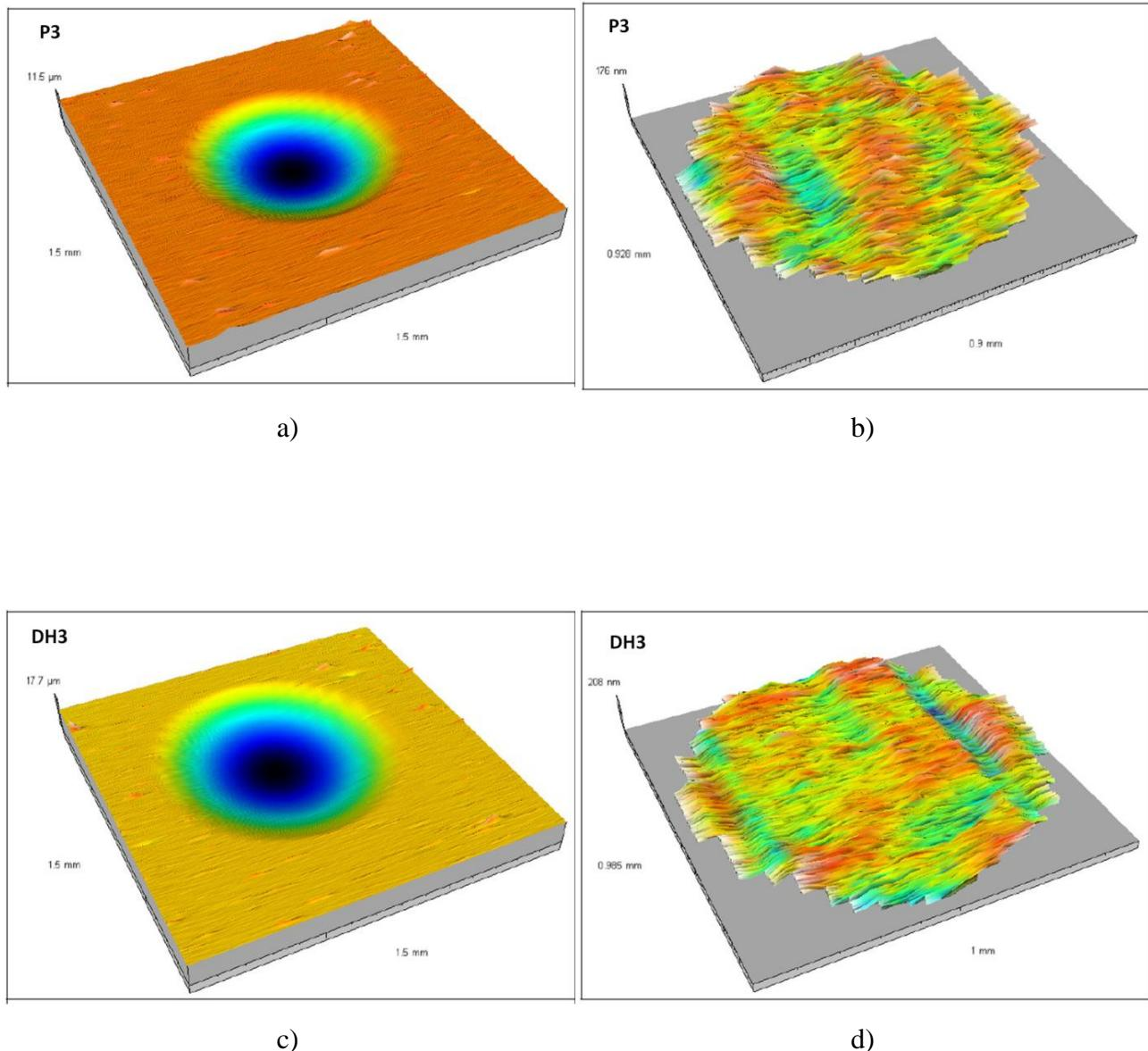
Slika 6.86: Trodimenzionalni prikaz traga trošenja i topografija nakon mikroabrazivskog ispitivanja kalotestom a) i b) uzorak P3 c) i d) uzorak DH3
