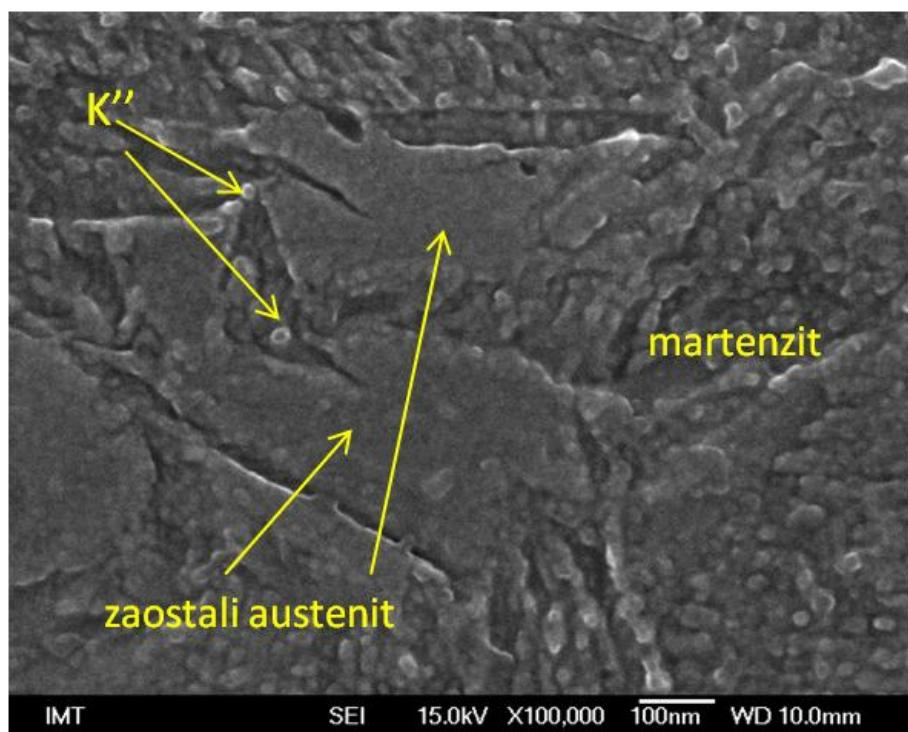
Slika 6.4: Mikrostruktura brzoreznog čelika PM S390 MC nakon kaljenja (austenitizacija na  $1130^{\circ}\text{C}/6$  min i gašenje u struji  $\text{N}_2$ ), veliko povećanje
