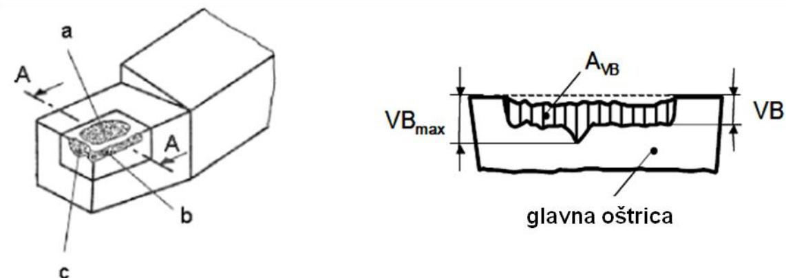
Slika 2.5: Trošenje stražnje površine alata,  $VB$  [15]
