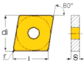
Slika 6.87: Pločica CNMA 120408 [66]
