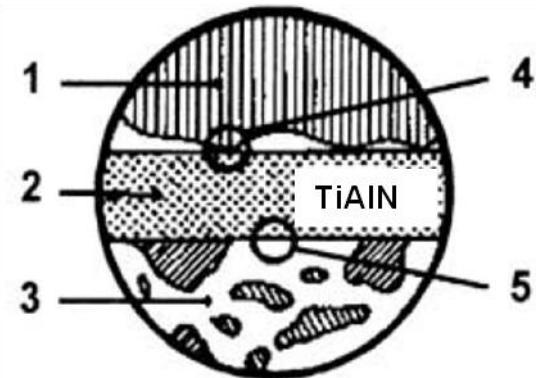
Slika 5.3: Shematski prikaz tribosustava „osnovni materijal/prevlaka/obradak“ [2]
