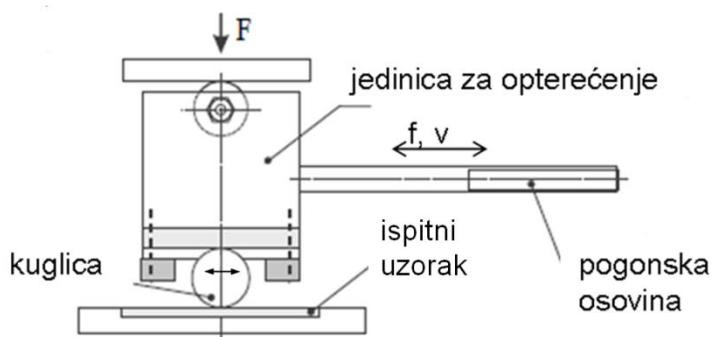
Slika 6.44: Shematski prikaz uređaja za ispitivanje trošenja metodom „kuglica na ploči“ [54]
