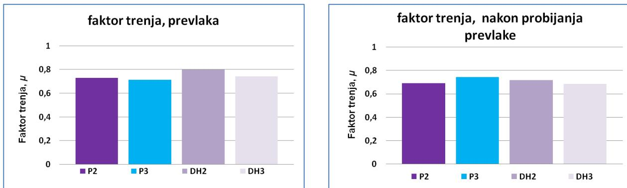
Slika 6.81: prosječni faktor trenja pri ispitivanju otpornosti na trošenje metodom „kuglica na ploči“: a) prevlaka, b) nakon probijanja prevlaka
