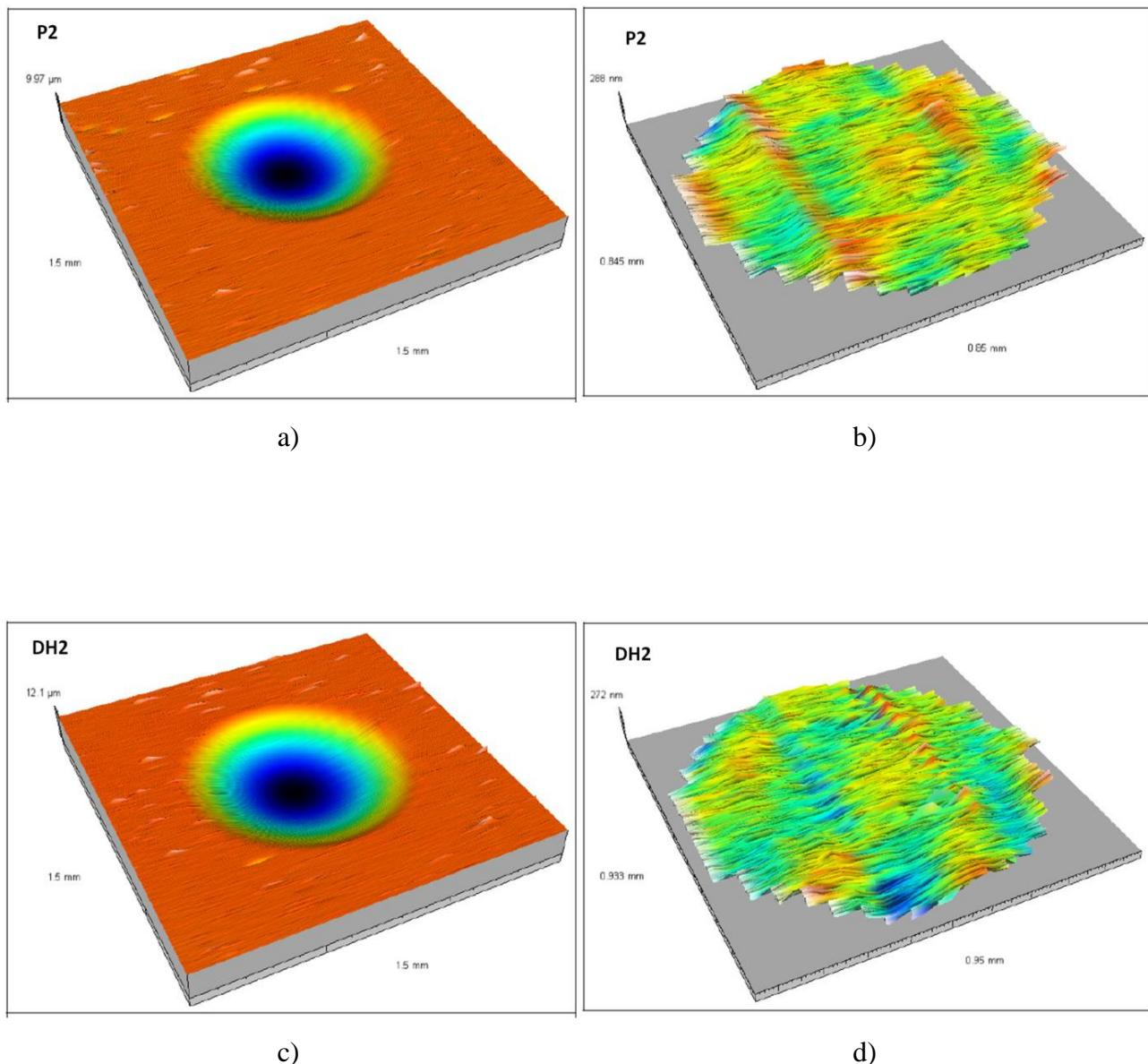
Slika 6.85: Trodimenzionalni prikaz traga trošenja i topografija nakon mikroabrazivskog ispitivanja kalotestom a) i b) uzorak P2, c) i d) uzorak DH2
