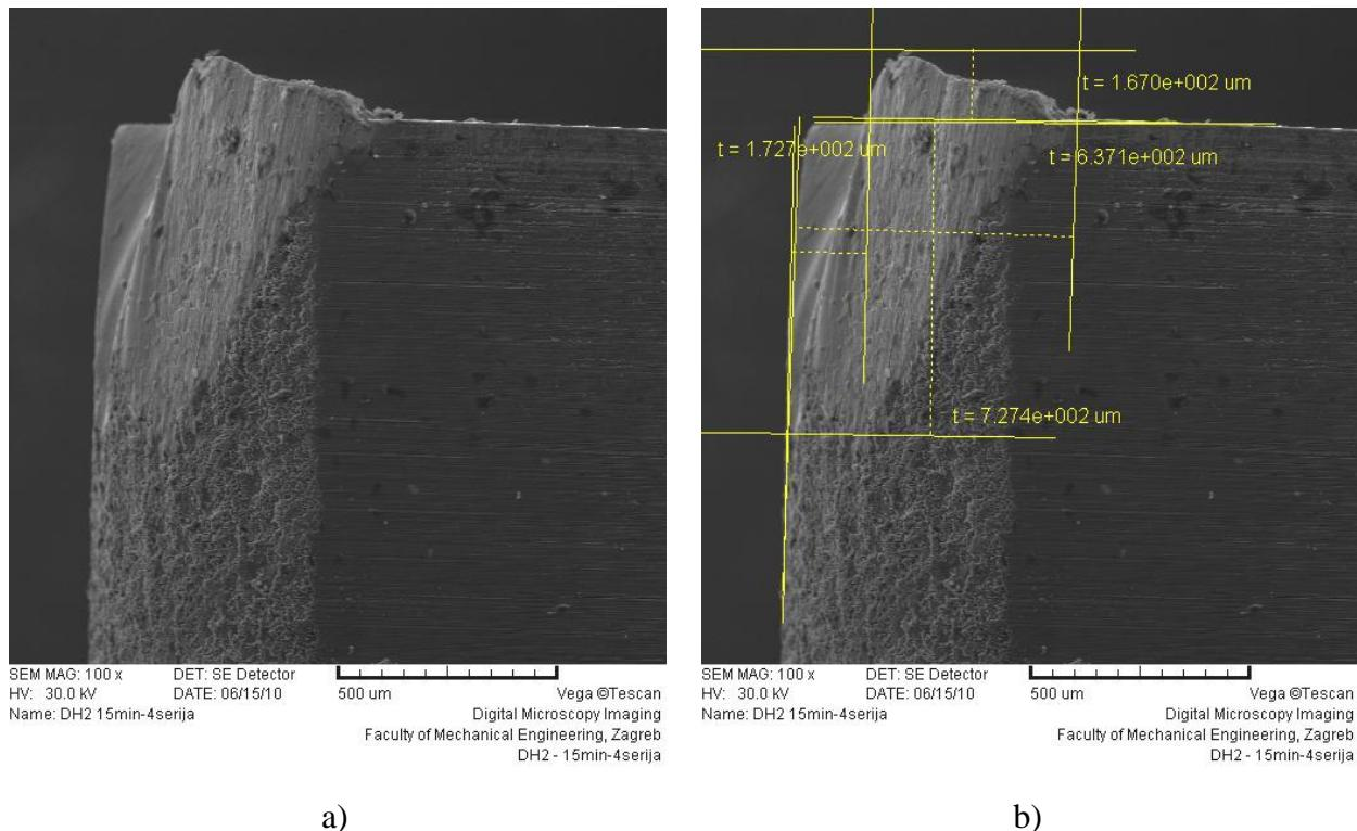
Slika 6.90: Rezna oštica od brzoreznog čelika PM S390 MC nakon ispitivanja trošenja
