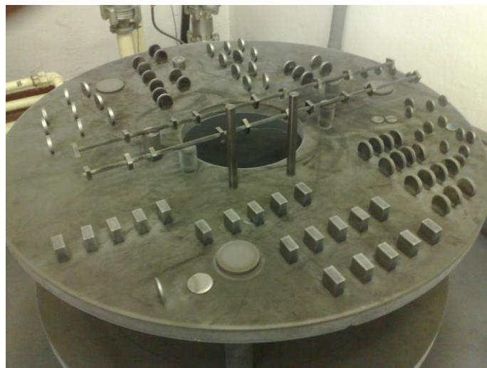
Slika 6.7: Uzorci nakon provedenog ionskog nitriranja
