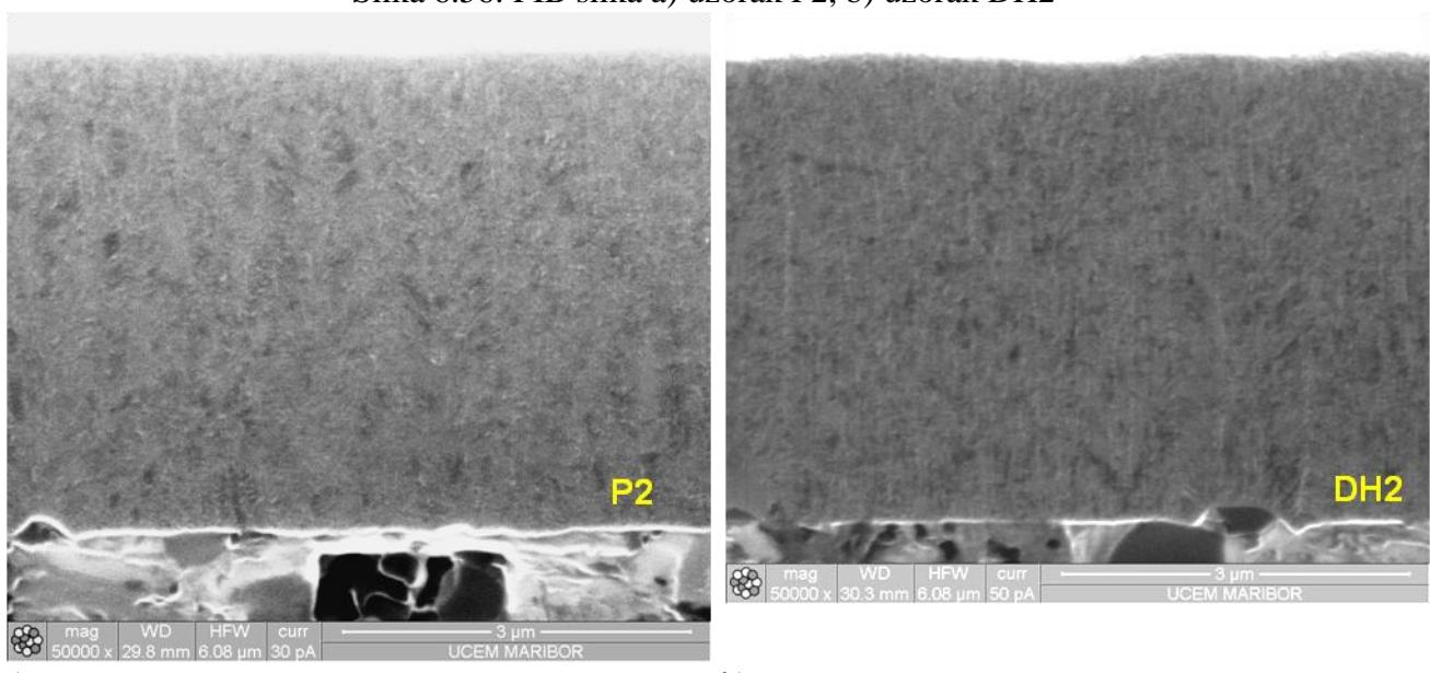
Slika 6.57: FIB slika TiAlN prevlake a) uzorak P2, b) uzorak DH2
