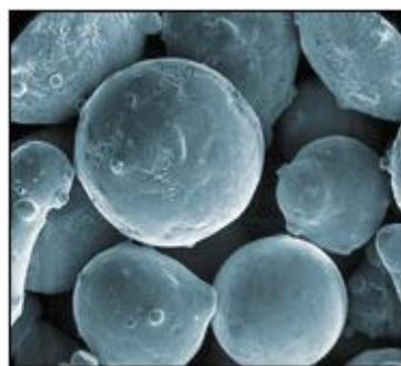
Slika 3.2: Prah za proizvodnju brzoreznog čelika Böhler Microclean [29]
