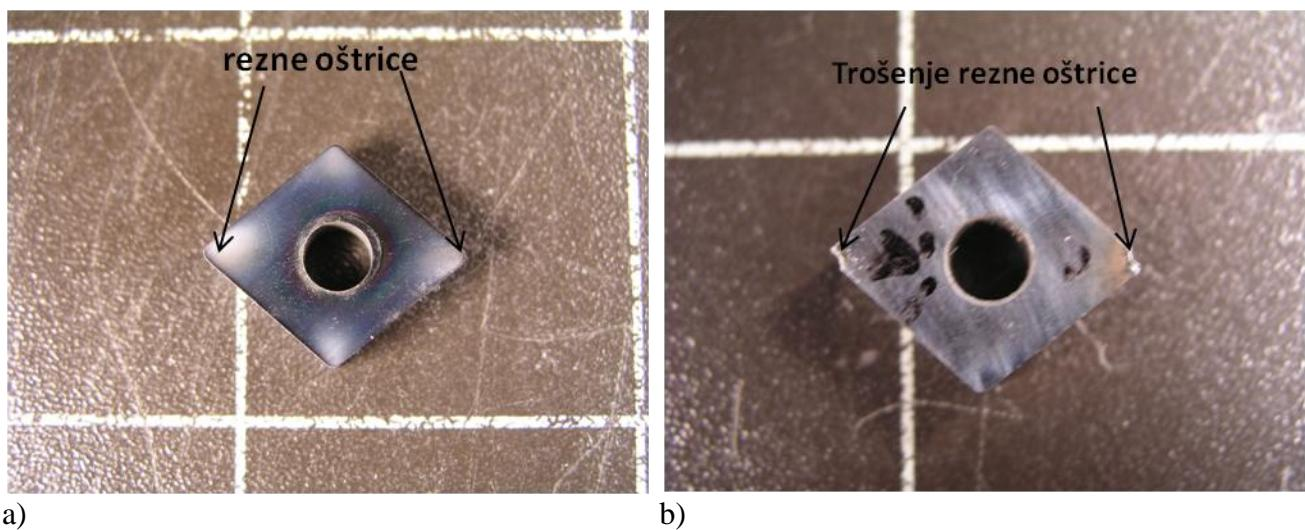
Slika 6.91: Rezne oštice CNMA 120408 a) nova pločica stanja DH2
