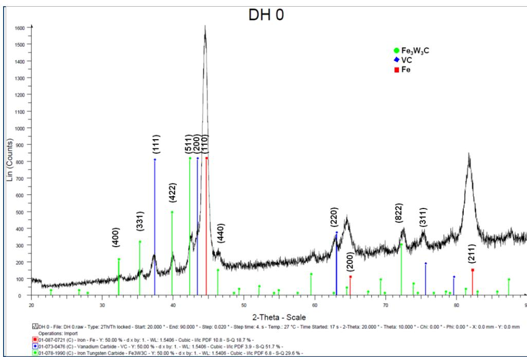
Slika 6.29: Rendgenogram uzorka stanja DH0 s markiranim pikovima  $\text{Fe}_3\text{W}_3\text{C}$ , VC i  $\alpha$  - Fe
