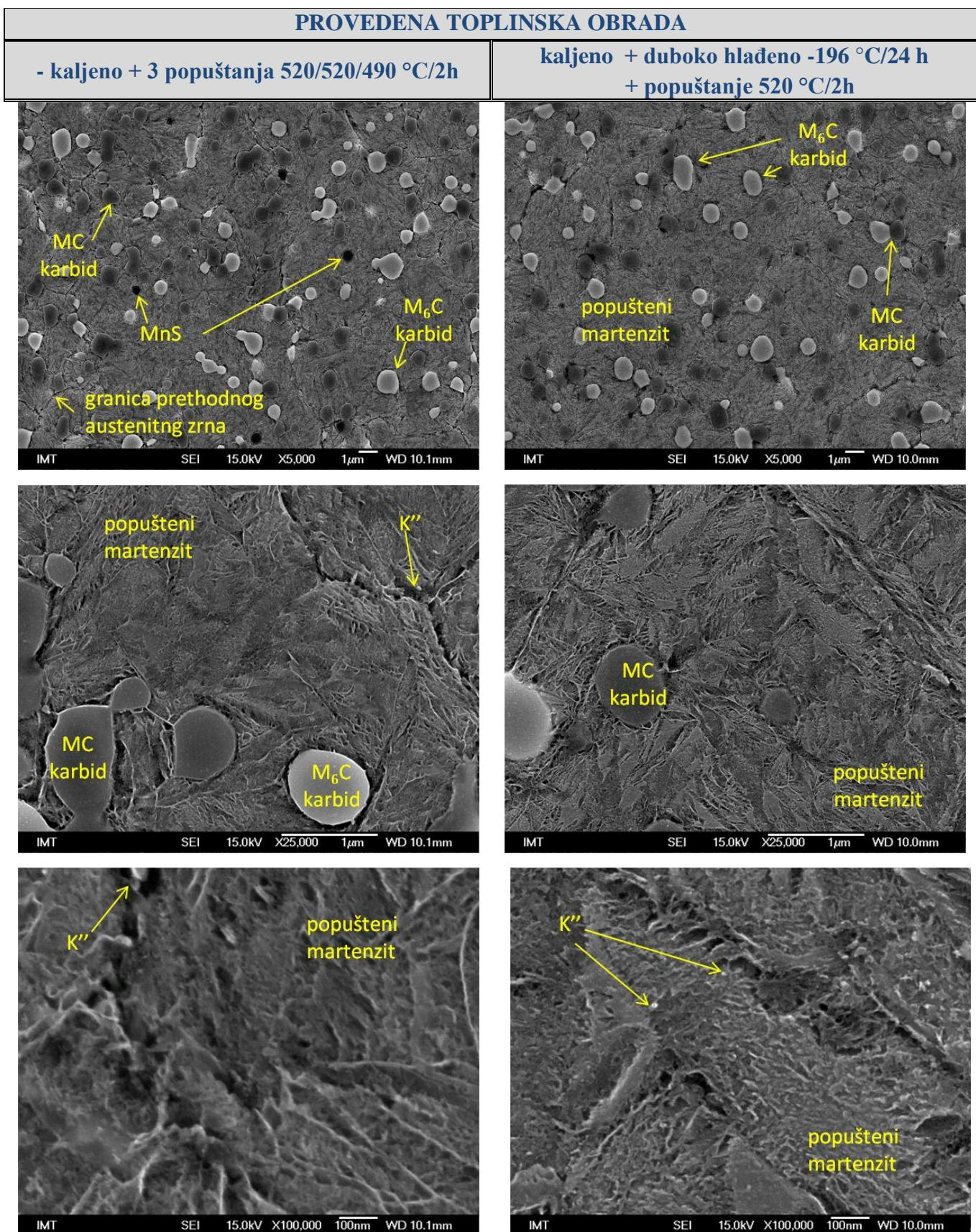
Slika 6.6: Mikrostruktura brzoreznog čelika PM S390 MC nakon provedenih toplinskih obrada
