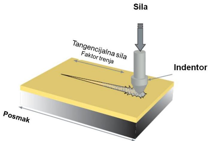
Slika 6.72: Shematski prikaz ispitivanja prionjivosti prevlake brazdanjem
