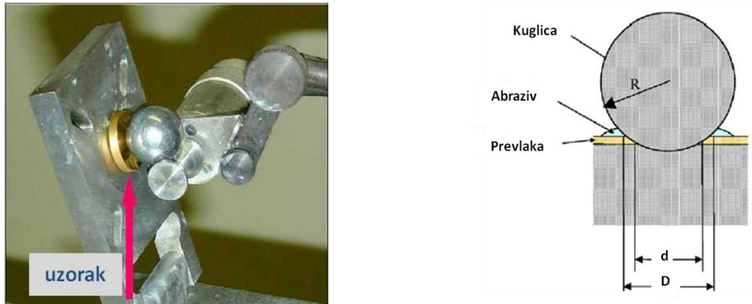
a) Slika 6.64: Metoda utiskivanja kuglice a) smještaj uzorka u uređaj b) princip ispitivanja
