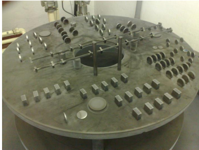
Slika 6.7: Uzorci nakon provedenog ionskog nitriranja
