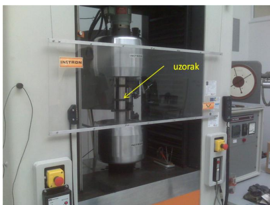
Slika 6.34: a) Univerzalni ispitni uređaj Instron 1255 b) Detalj sa slike a)
