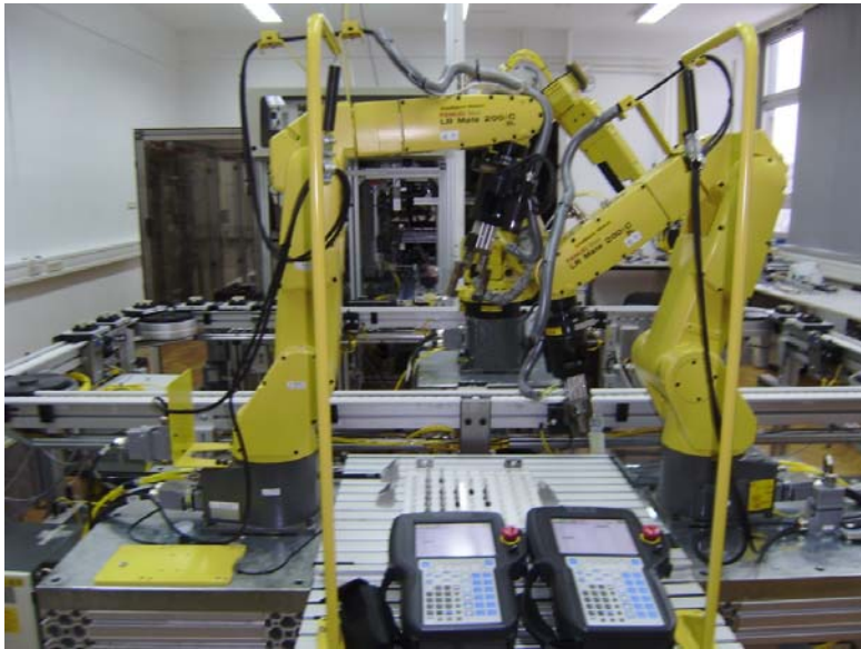
Slika 1-2. Dva robota koji dijele radni prostor. Laboratorij za projektiranje izradbenih i montažnih sustava.
