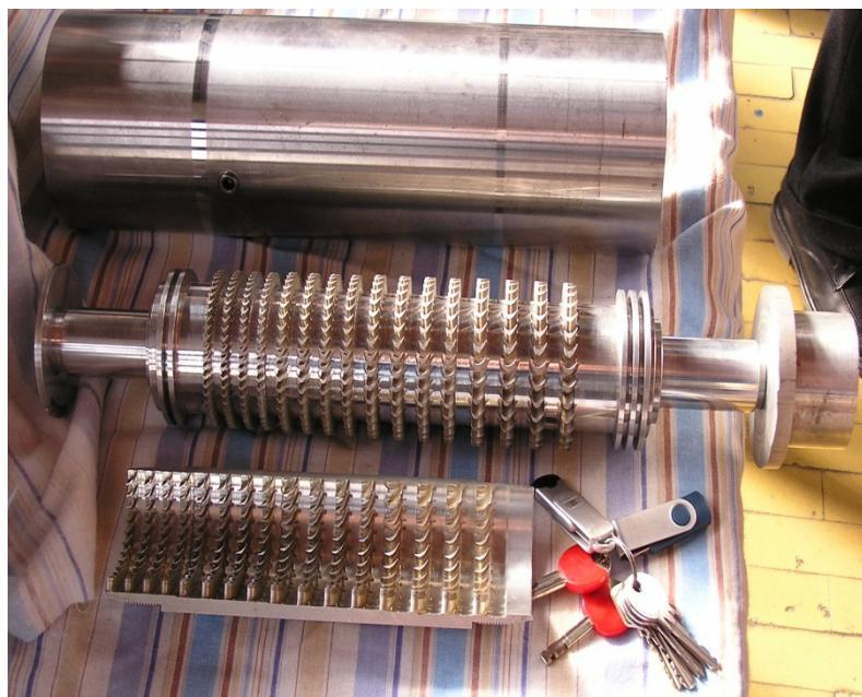
Slika 13 Dijelovi plinske turbine: vanjsko kućište, rotor i segment sa statorskim lopaticama
