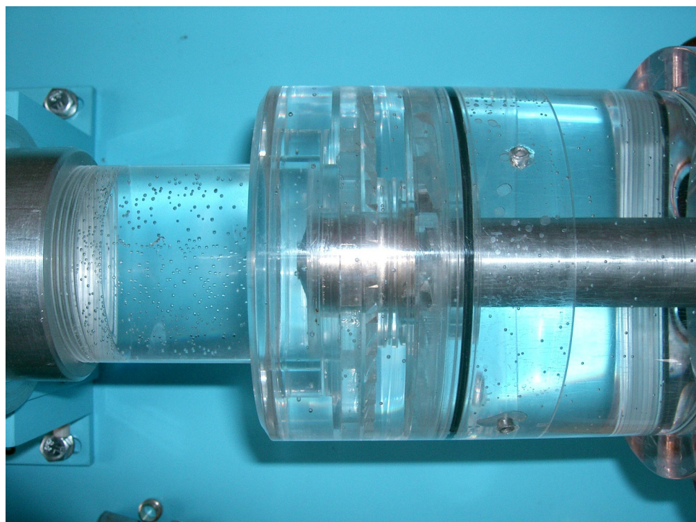
Slika 27 Kućište s ugrađenim stupnjem koji se ispituje
