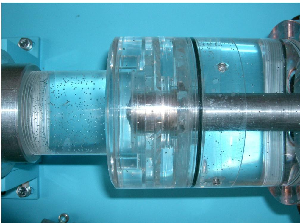
Slika 27 Kućište s ugrađenim stupnjem koji se ispituje
