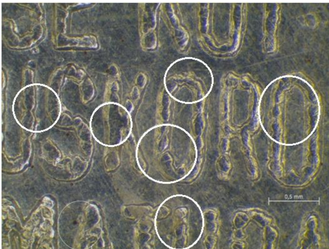
Slika 59. Površina uzorka od Al 99,5 veličine zrna 76\mu\text{m} kod ukupne deformacije 800\mu\text{m} .
