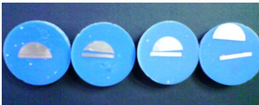
Slika 15. Izrezani i obrađeni ispitni uzorci pripremljeni za daljnu mikroskopsku analizu mikrostrukture.
