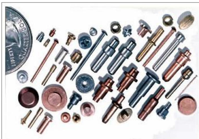
Slika 9. Neki od proizvoda dobivenih procesom mikrooblikovanja u hladnom stanju [13].
