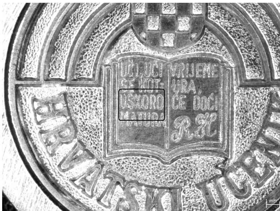
Slika 58. Površina ispitnog uzorka sa označenim detaljem na kojem je provedena analiza kvalitete otiska.
