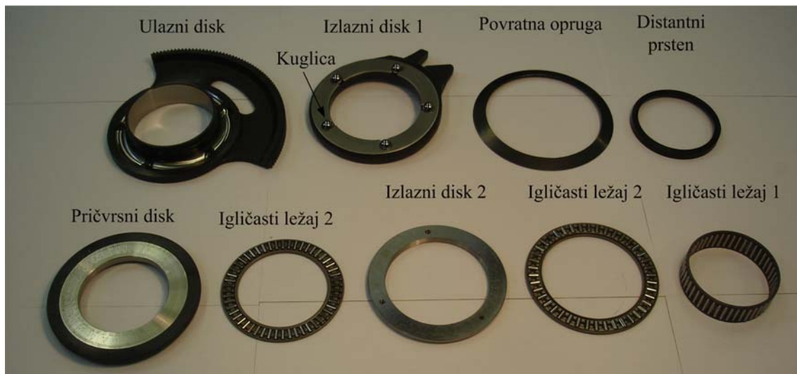
Slika 7-3. Fotografija elemenata mehanizma s kuglicama na rampi.
