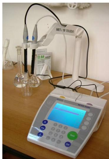
**Slika 3.21** Uredaj pH-metar/konduktometar
