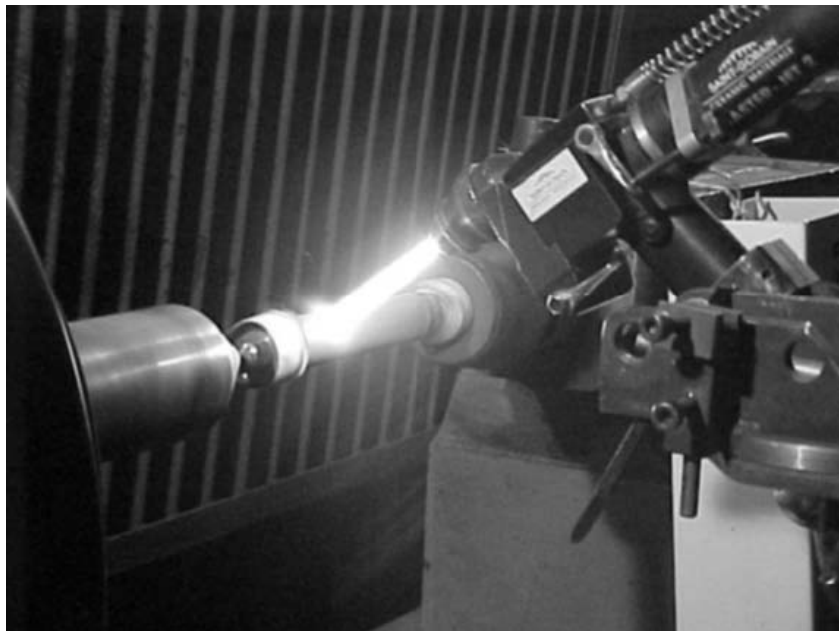
Slika 2.7 Plinski pištolj novije generacije za naštrcavanje žicom [29].
