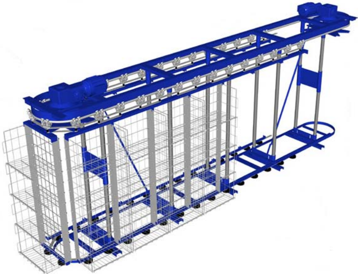
Slika 31. Horizontalni karusel (Daimond Phoenix)
