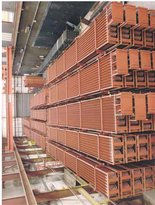
1.13. Uskladištene modularno napravljene izmjenjivačke površine
