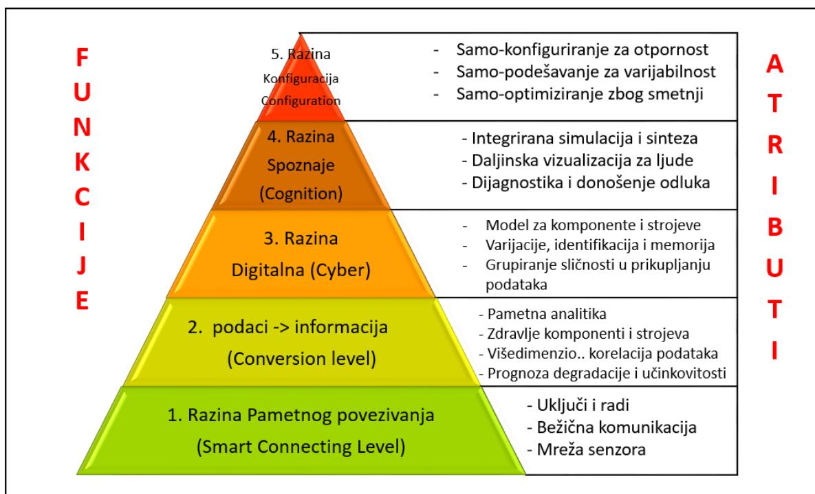
Slika 4.4: Koncept 5C arhitekture za izgradnju CPS sustava [142];
