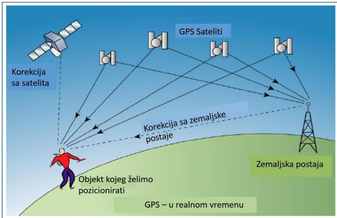
Slika 4.9: Koncept globalnog položajnog sustava GPS [159];
