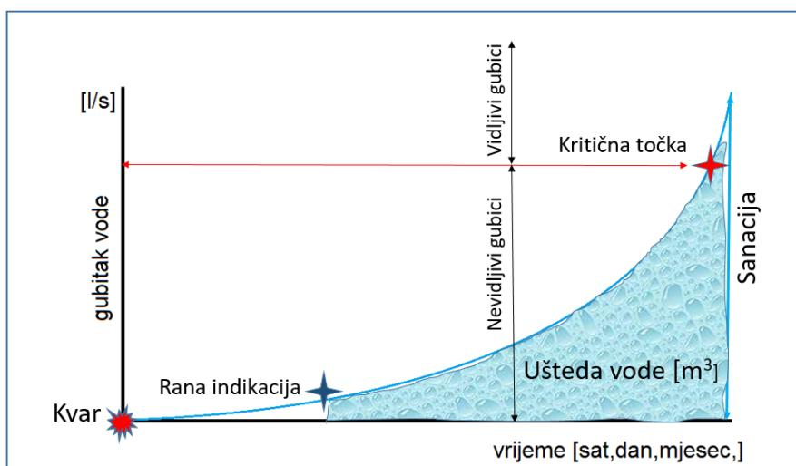
Slika 5.6: Shematski prikaz uštede vode primjenom RIGV metode;
