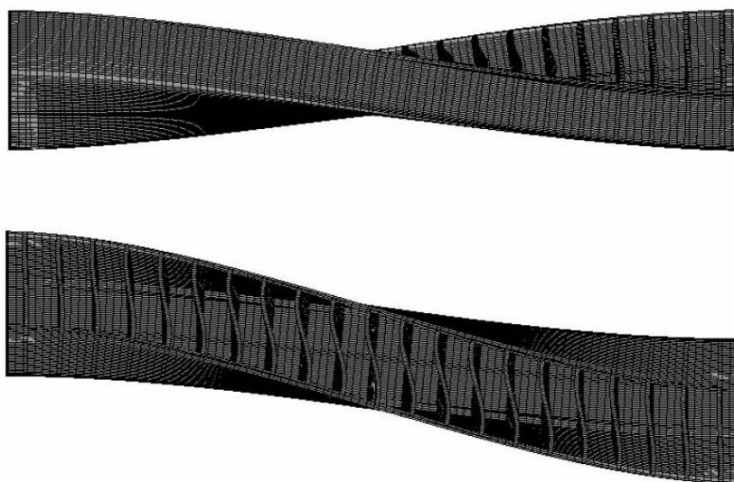
Slika 5.20 Deformacija jednolikog pontona s pregradama, bočni i ptičji pogled
