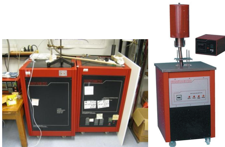
Slika 46 Termometrijske peći ra realizaciju fazne promjene u otvorenim fiksnim točkama.
