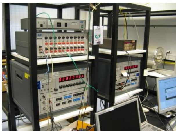
Slika 38 Otporni mjerni mostovi ASL F18
