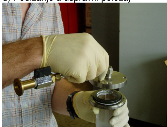
f) Montaža prirubnice
