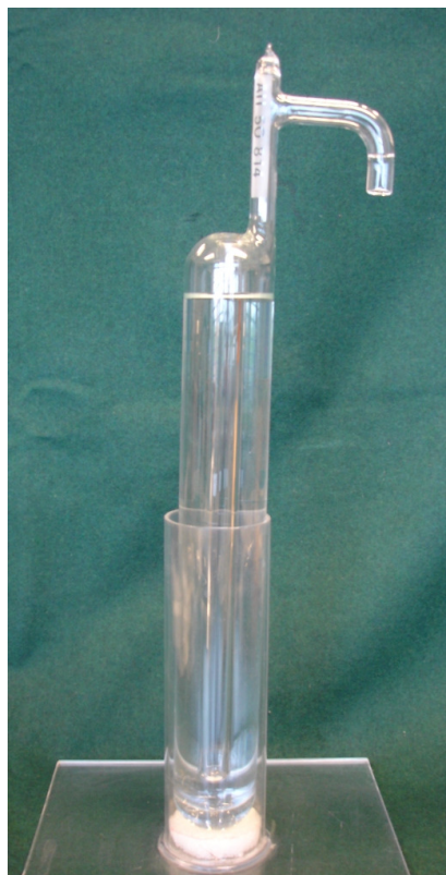
Slika 30 Trojna točka vode Isotech model E11
