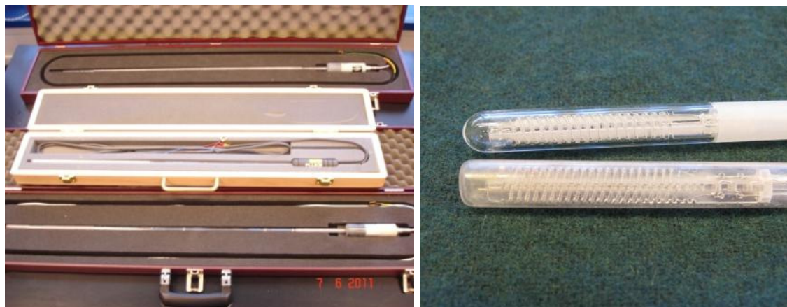
Slika 35 Etalonski platinski otporni termometri korišteni za interpolaciju temperature između fiksnih točaka. Različite izvedbe osjetnika termometra.
