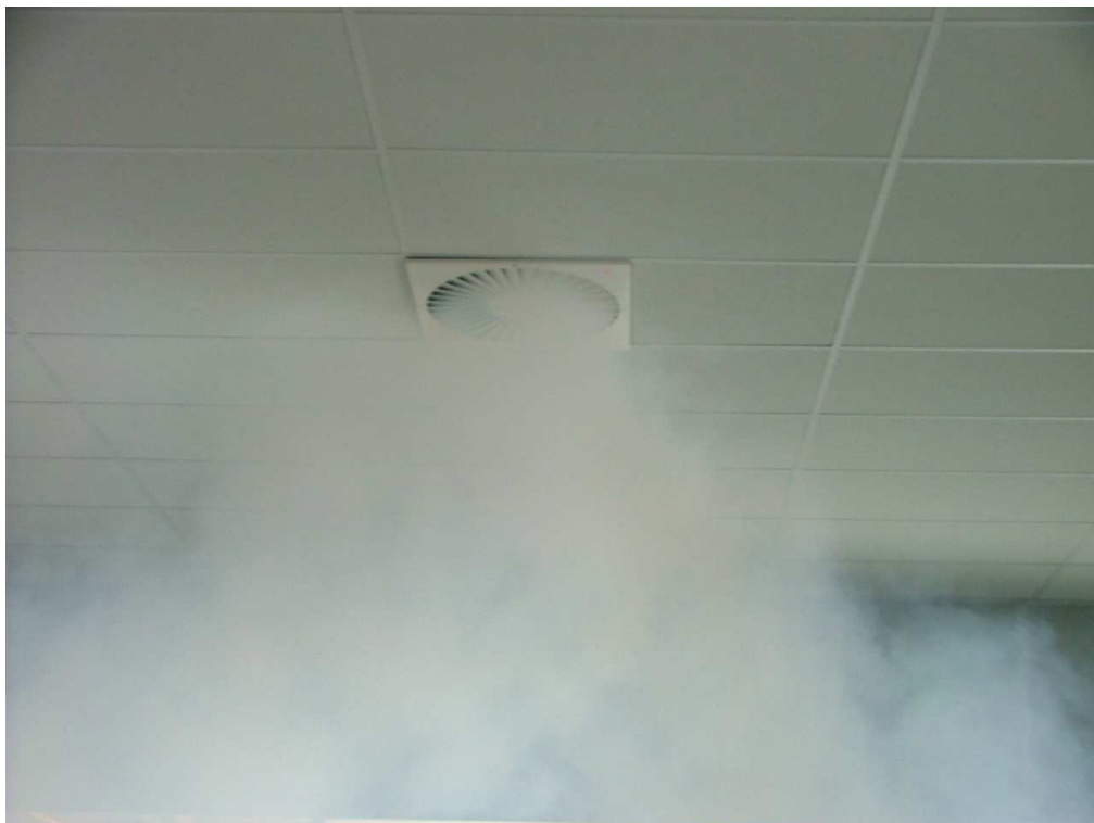
Slika 5.11 Izostanak priljubljenja mlaza kod ploče bez prstena
