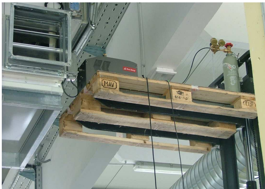
Slika 5.5 Uređaj za vizualizaciju strujanja s potisnim plinom CO 2 na usisu klima jedinice
