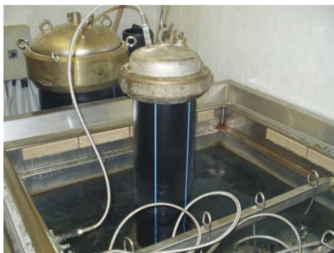
Slika 126. Uranjanje cijevi od PE100 u bazen ispitne stanice [99]
