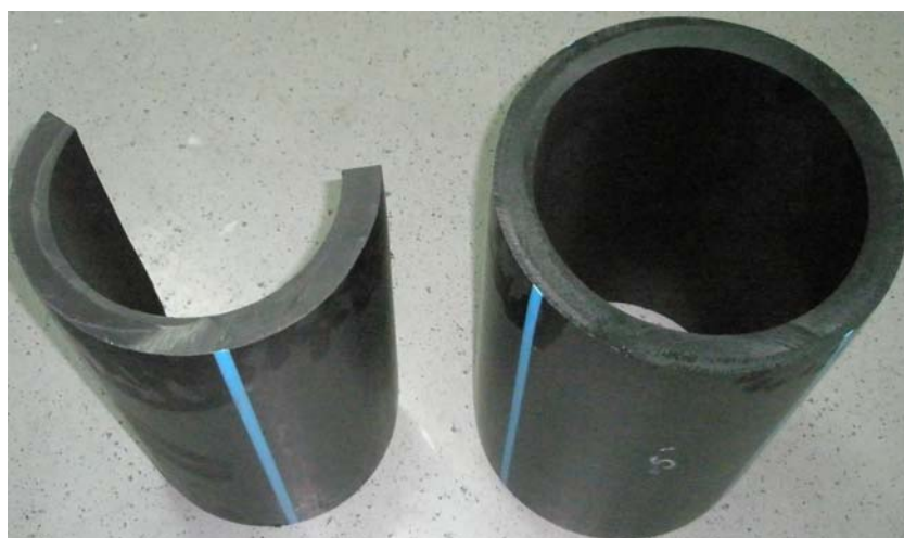
Slika 146. Cijevi od polietilena PE100, ustupio PipeLife d.o.o., Karlovac, za izradu osnosimetričnih epruveta s potpunim obodnim zarezom
