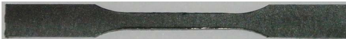
Slika 135. Epruveta 1BA od polietilena PE100 za vlačno ispitivanje polimera
