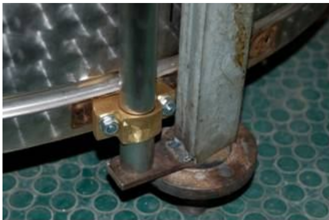
Slika 3.5: Vodilice od mjedi i cijev za vođenje
