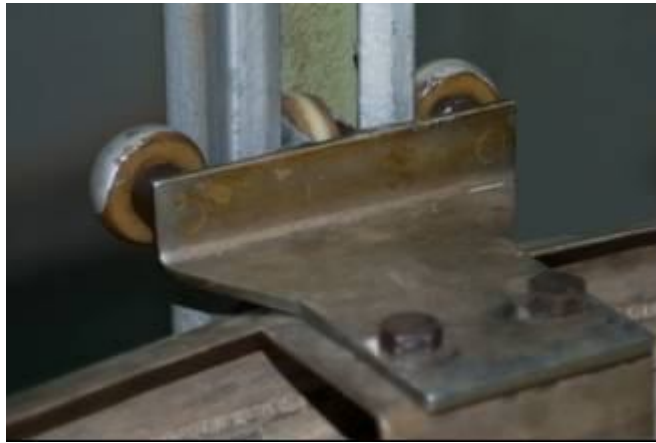
Slika 3.4: Vodilice s kotačićima
