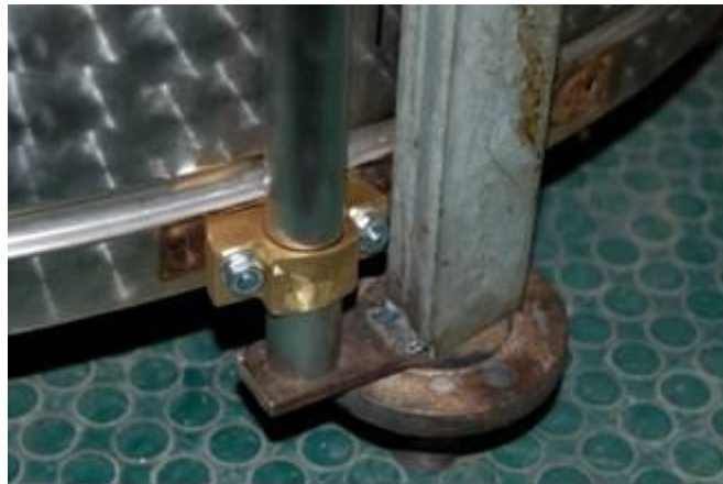
Slika 3.5: Vodilice od mjedi i cijev za vođenje
