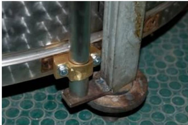
Slika 3.5: Vodilice od mjedi i cijev za vođenje
