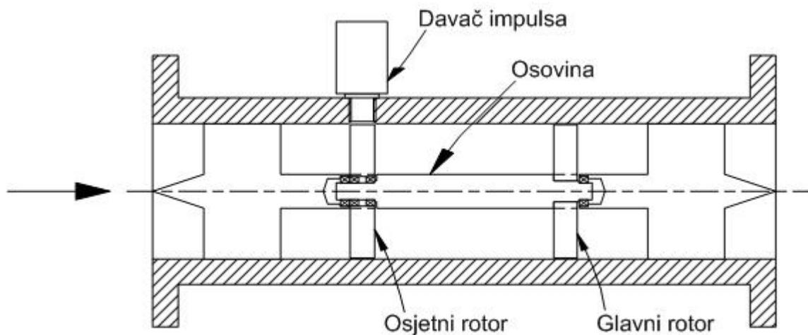
Slika 2.14: Shematski prikaz mjerila protoka Quantum Dynamics
