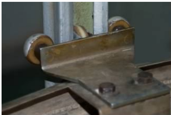
Slika 3.4: Vodilice s kotačićima
