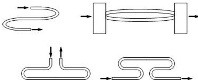
Slika 2.18: Oblici cijevi za Coriolisova mjerila protoka
