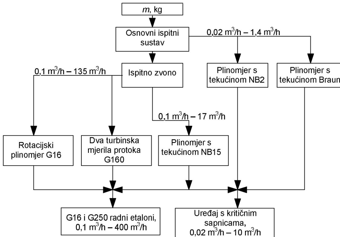
Slika 1.1: Lanac sljedivosti pri umjeravanju radnih etalona protoka plina
