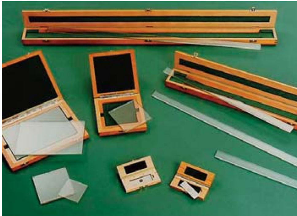
Slika 2. Mjerne skale različitih duljina i izvedbi
