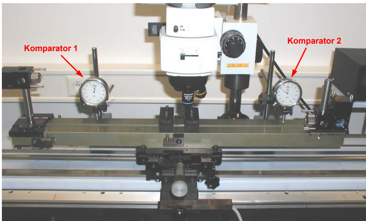
Slika 94. Mjerenja zakreta stola provedeno s dva komparatora
