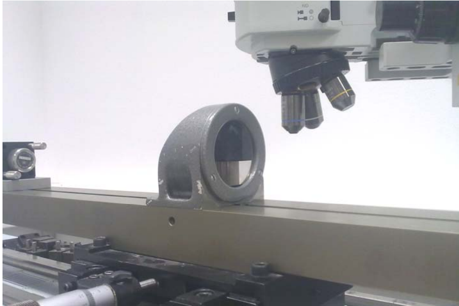
Slika 113. Postavljanje reflektora autokolimatora
