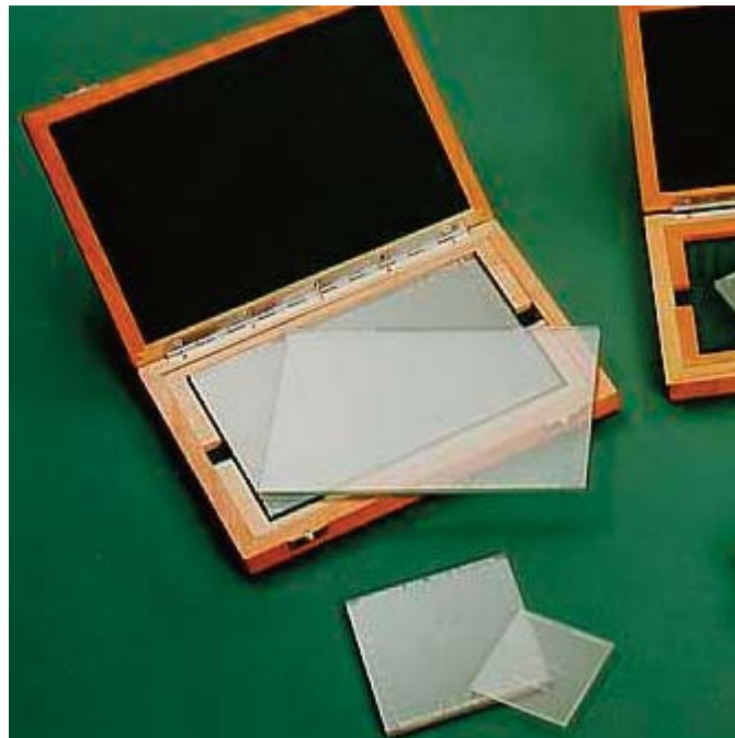
Slika 4. Dvodimenzionalna mjerna skala
