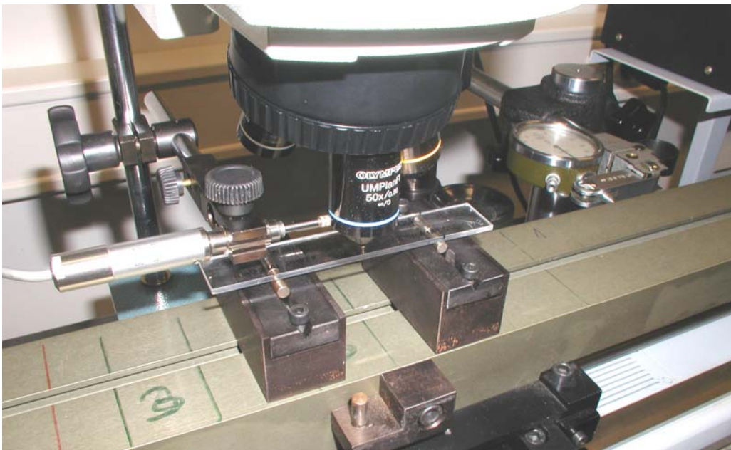
Slika 117. Mjerenje pomaka objektivna pomoću elektronskog komparatora
