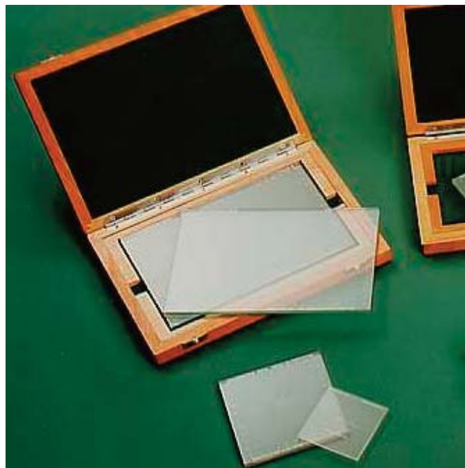
Slika 4. Dvodimenzionalna mjerna skala
