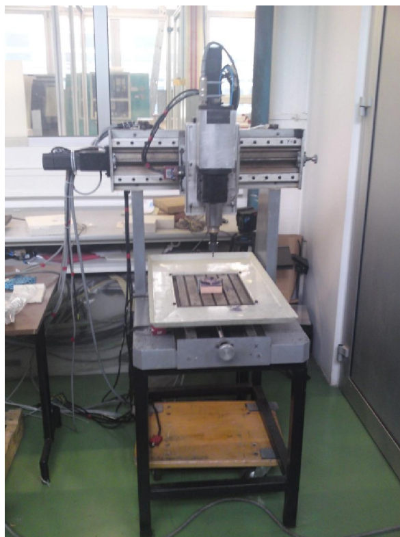
Slika 17.b) Mala portalna CNC glodalica
