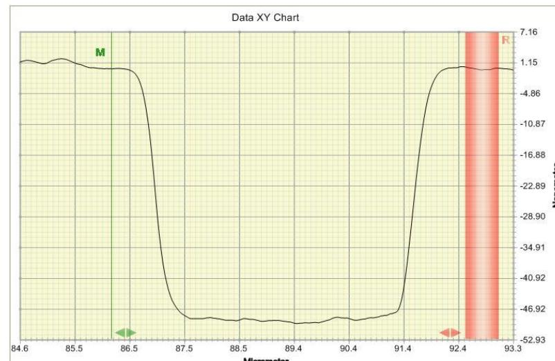
Slika 7.22 Brazde širine 5 µm na etalonu oznake REH 50/2
