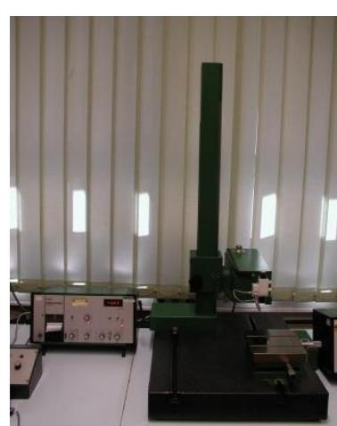
Slika 5.3 Elektroničko-mehanički uređaj s ticalom *Perthometer C5D*
