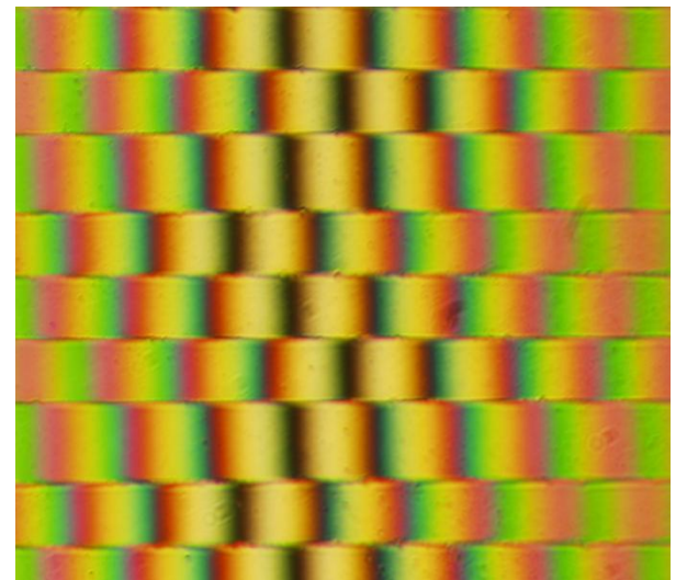
Slika 6.21 Etalon nazivne dubine brazde 200 nm. Interferogram na površini prevučenoj kromom
