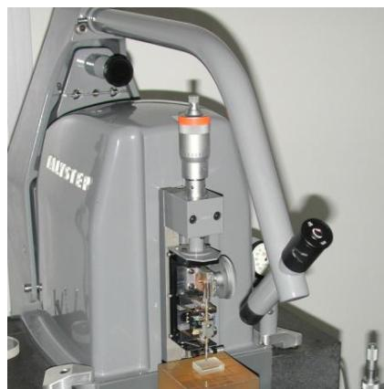
Slika 5.4 Uređaj s ticalom *Talystep 1*
