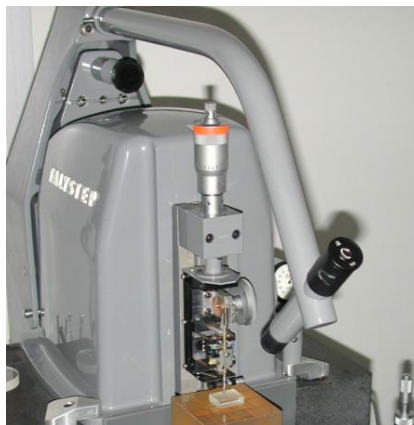
Slika 5.4 Uređaj s ticalom Talystep 1
