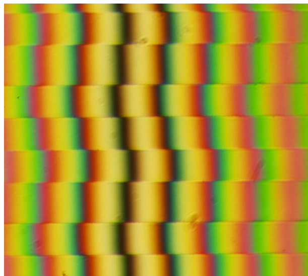
Slika 6.19 Etalon nazivne dubine brazde 50 nm. Interferogram na površini prevučenoj kromom
