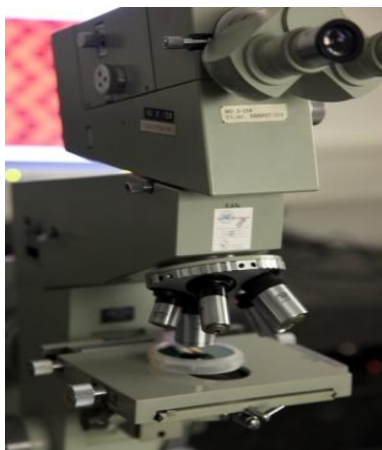
Slika 5.1 Interferencijski mikroskop Epival-Interphako
