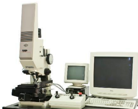
Slika 5.6 Interferometar Zygo NewView 200
