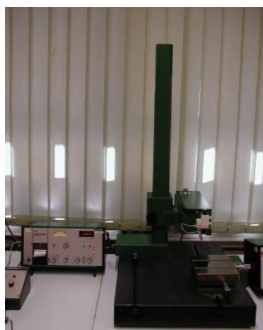
Slika 5.3 Elektroničko-mehanički uređaj s ticalom Perthometer C5D
