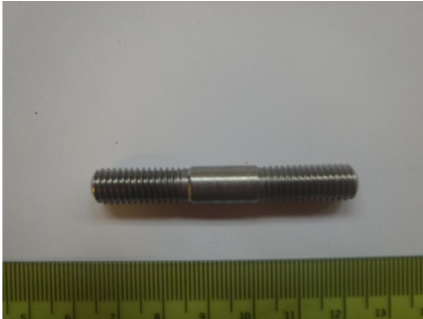
Slika 3.9 Implant uzorak s obostranim navojem
