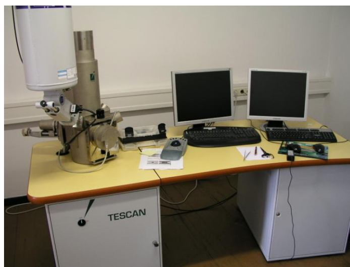
Slika 4.38 SEM uređaj u Laboratoriju za materijalografiju, Fakulteta strojarstva i brodogradnje [75]
