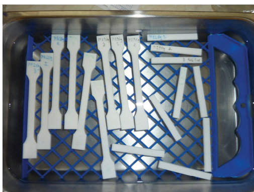
Slika 8.24. Ispitivanje apsorpcije vode
