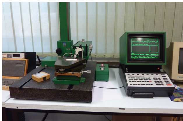
Slika 6.14. Uređaj za ispitivanje hrapavosti površine
