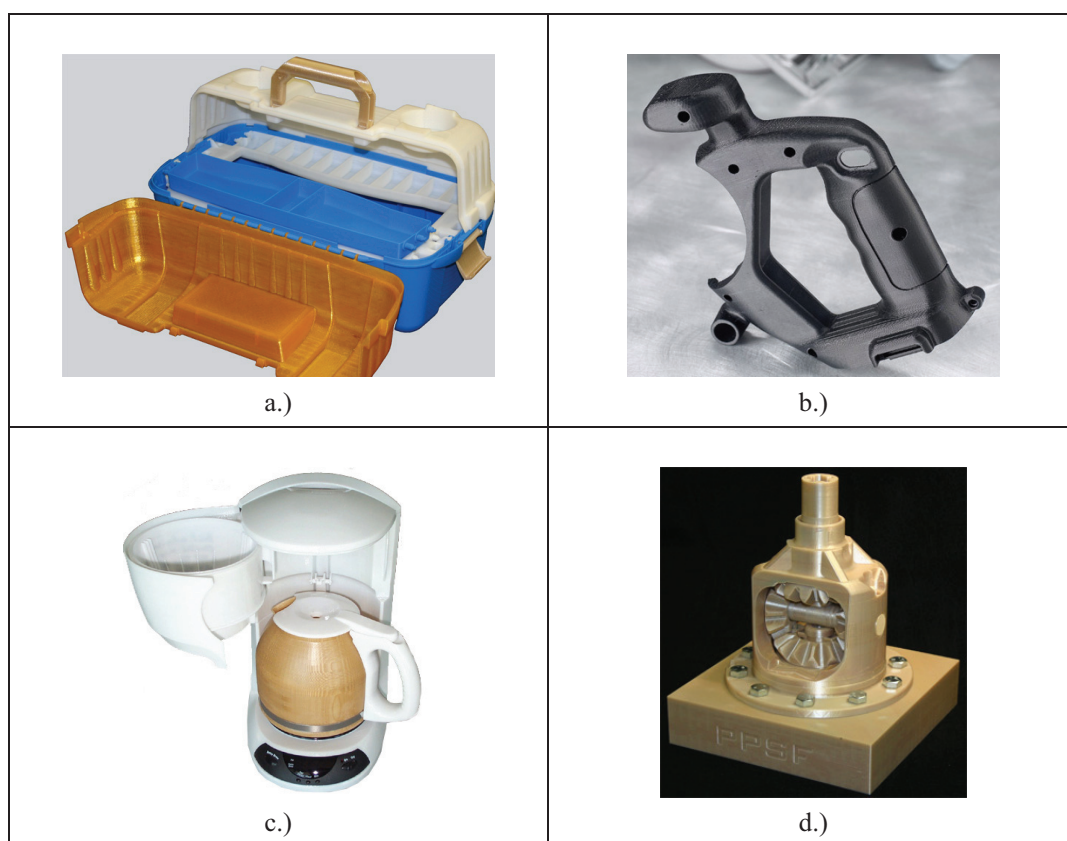
Slika 4.15. Prototipovi izrađeni FDM postupkom: a.) ABS kutija za alat, b.) PC-ABS ručka alata, c.) PC aparat za tople napitke, d.) PPSF kućište zupčanika [35]
