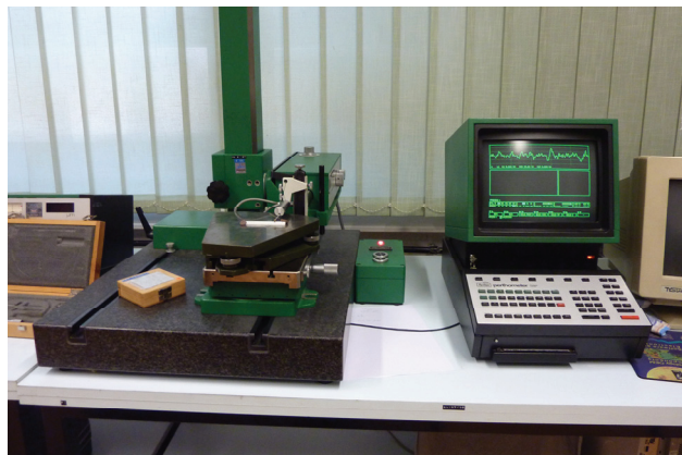
Slika 6.14. Uređaj za ispitivanje hrapavosti površine
