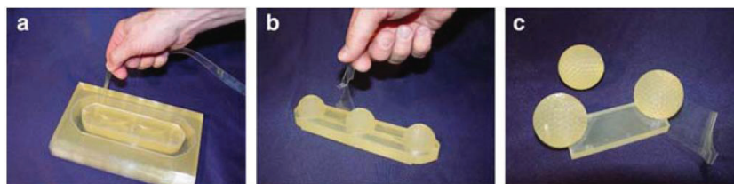
Slika 4.17. Postupak odvajanja viška materijala [12]
