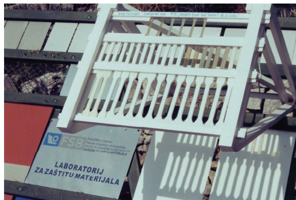
Slika 6.13. Terenska ispitivanja utjecaja atmosferilija
