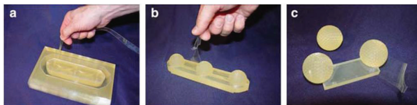
Slika 4.17. Postupak odvajanja viška materijala [12]
