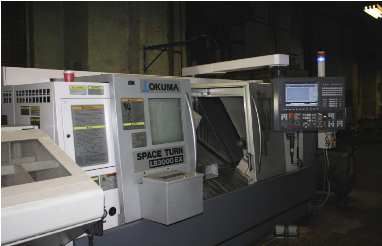
Slika 11: CNC obradni centar OKUMA SPACE TURN LB3000 EX
