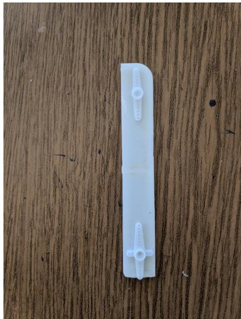
**Slika 3.2. Štap unutarnje ruke s uglavljenjima za motore**
