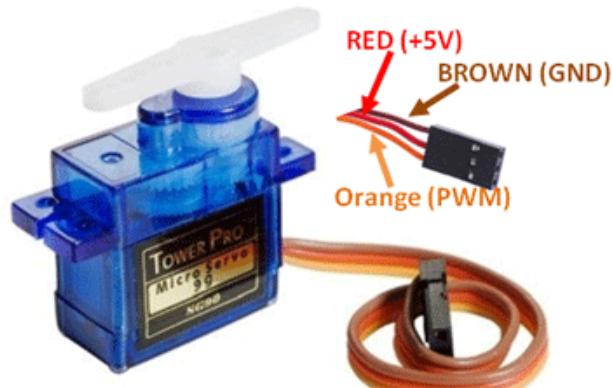
Slika 2.8. Servo motor *Tower Pro SG90* [10]
