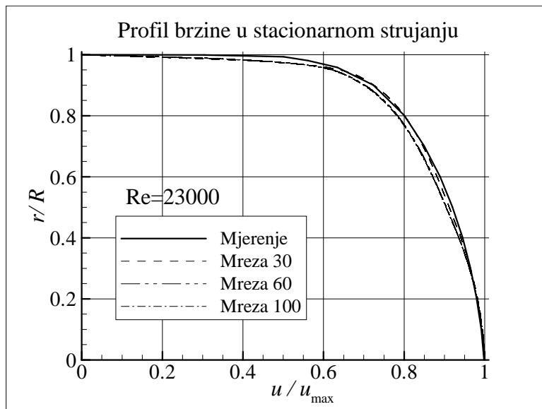
Sl. 4.6 Usporedba profila brzine pri  $Re=23.000$  dobivenih numeričkom integracijom modela turbulencije na mrežama s 30, 60 i 100 elemenata u radijalnom smjeru ( $q=1,08$  za sve tri mreže) s eksperimentalno dobivenim profilom [57]
