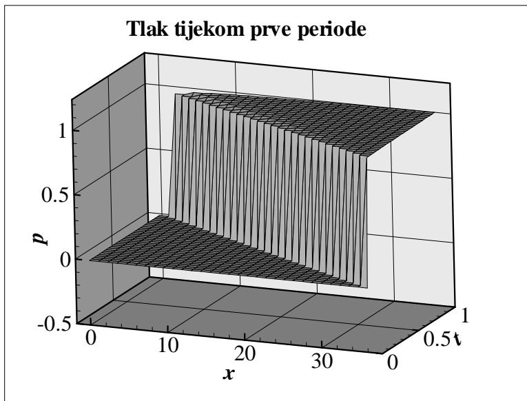
Sl. 4.46 Raspored tlaka duž cijevi u prvoj periodi ( $tc/L=0\div 1$ ) u zavisnosti od udaljenosti  $x$  i vremena  $t$
