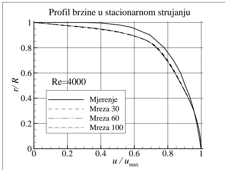
Sl. 4.5 Usporedba profila brzine pri  $Re=4.000$  dobivenih numeričkom integracijom modela turbulencije na mrežama s 30, 60 i 100 elemenata u radijalnom smjeru ( $q=1,05$  za sve tri mreže) s eksperimentalno dobivenim profilom [57]
