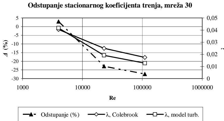
Sl. 4.2 Koeficijent trenja  $\lambda$  prema Colebrookovom izrazu i  $\lambda_{MT}$  dobiven integracijom modela turbulencije na mreži od 30 elemenata, te njegovo odstupanje ( $\Delta$ ) od  $\lambda$ , za vrijednosti Reynoldsovog br.: 4000 ( $q=1,05$ ), 23000 ( $q=1,08$ ) i 110000 ( $q=1,15$ )
