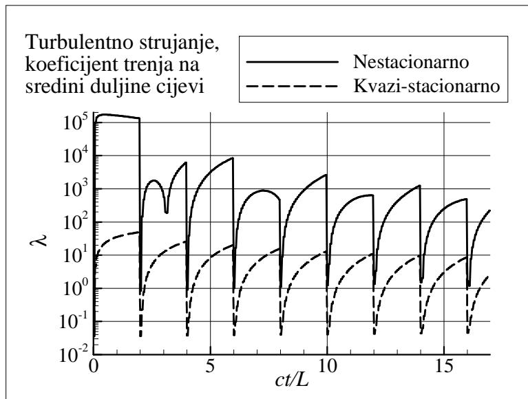
Sl. 4.39 Tijek koeficijenta trenja, nestacionarnog (određen iz smičnog naprezanja  $\tau_w$ ) i kvazi-stacionarnog (određen prema vrijednosti  $\text{Re}$ )
