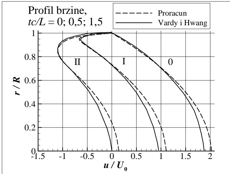
Sl. 4.21 Profili brzine na sredini duljine cijevi 'ubrzano' nakon prolaska prva dva poremećaja, proračunati prema predloženoj metodi i prema metodi Vardy i Hwang [9]
