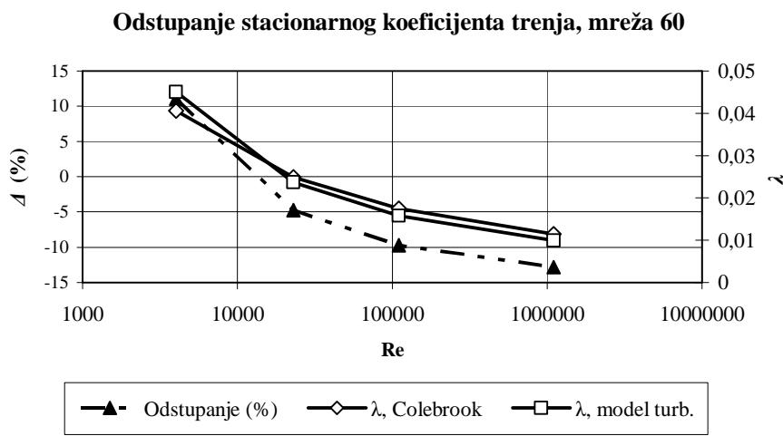
Sl. 4.3 Koeficijent trenja  $\lambda$  prema Colebrookovom izrazu i  $\lambda_{MT}$  dobiven integracijom modela turbulencije na mreži od 60 elemenata, te njegovo odstupanje ( $\Delta$ ) od  $\lambda$ , za vrijednosti Reynoldsovog br.: 4000 ( $q=1,05$ ), 23000 ( $q=1,08$ ), 110000 ( $q=1,1$ ) i 1100000 ( $q=1,15$ )
