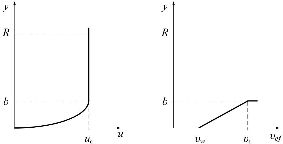
Sl. 2.3 Stacionarni profil brzine i efektivne viskoznosti [17]
