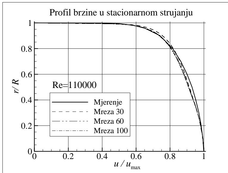
Sl. 4.7 Usporedba profila brzine pri  $Re=110.000$  dobivenih numeričkom integracijom modela turbulencije na mrežama s 30 ( $q=1,15$ ), 60 ( $q=1,1$ ) i 100 ( $q=1,1$ ) elemenata u radijalnom smjeru s eksperimentalno dobivenim profilom [57]
