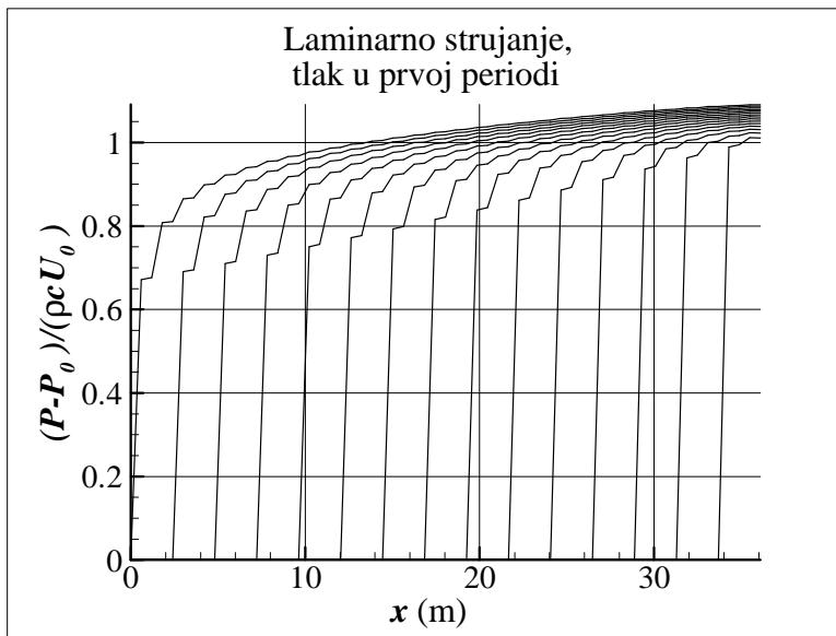
Sl. 4.25 Raspored tlaka duž cijevi u prvoj periodi ( $tc/L=0\div 1$ ) prikazan u svakom četvrtom vremenskom koraku
