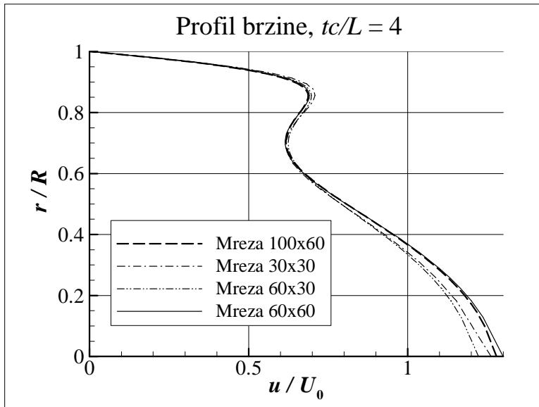
Sl. 4.20 Profil brzine na sredini duljine cijevi u trenutku  $tc/L = 4$
