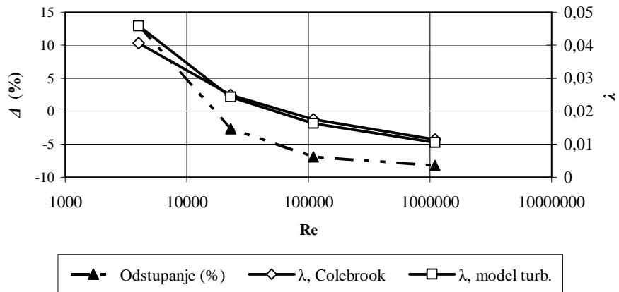
Sl. 4.4 Koeficijent trenja  $\lambda$  prema Colebrookovom izrazu i  $\lambda_{MT}$  dobiven integracijom modela turbulencije na mreži od 100 elemenata, te njegovo odstupanje ( $\Delta$ ) od  $\lambda$ , za vrijednosti Reynoldsova br.: 4000 (q=1,05), 23000 (q=1,08), 110000 (q=1,1) i 1100000 (q=1,1)
