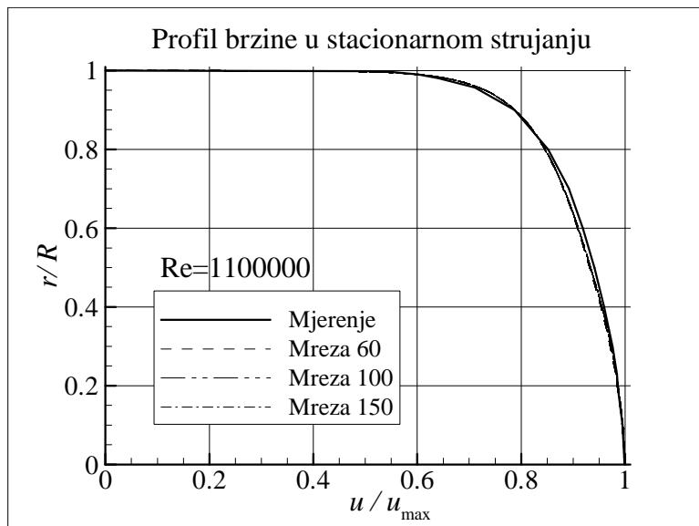
Sl. 4.8 Usporedba profila brzine pri  $Re=1.100.000$  dobivenih numeričkom integracijom modela turbulencije na mrežama s 60 ( $q=1,15$ ), 100 ( $q=1,1$ ) i 150 ( $q=1,1$ ) elemenata u radijalnom smjeru s eksperimentalno dobivenim profilom [57]
