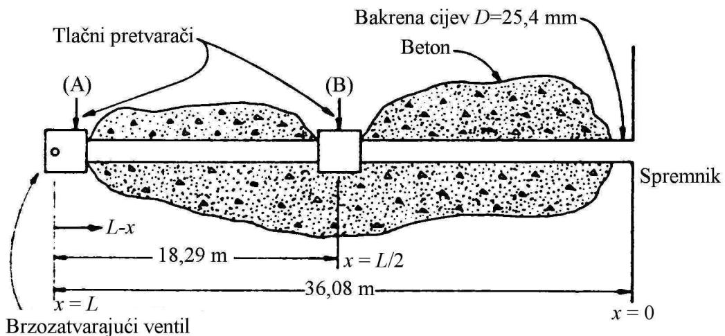
Sl. 4.9 Shema uređaja za ispitivanje hidrauličkog udara [58]
