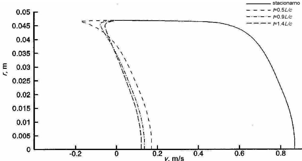
Sl. 2.1 Profili brzine pri hidrauličkom udaru [4]
